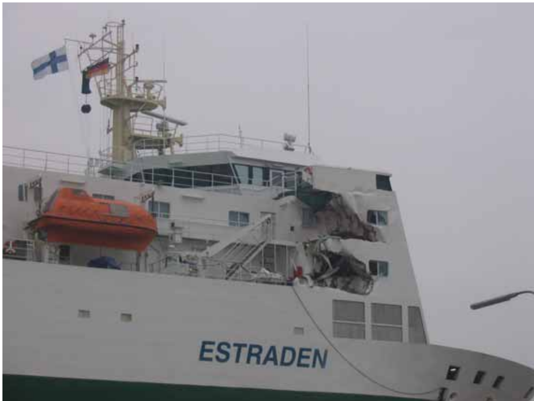
Kuva 13. ESTRADENin vaurioita SB-puolella.
