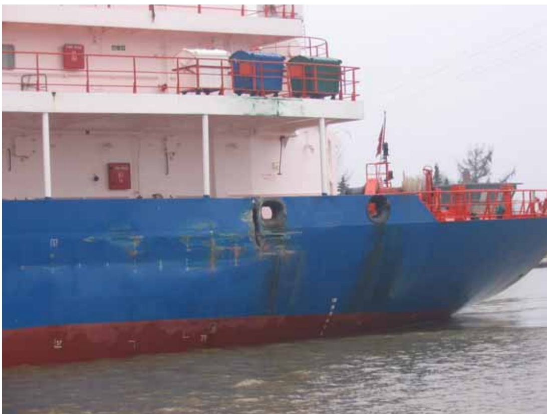
Kuva 18. WOLGASTERNin kyljessä olevia vaurioita.
