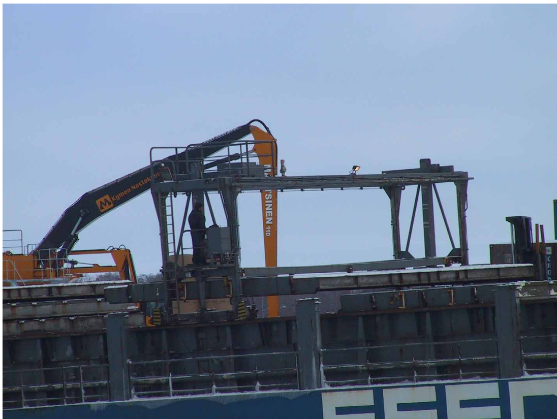
Kuva 12. Luukkujen siirto lastauksen aikana. Nosturin ohjauspaikka on tässä aluk- sessa nosturin sivulla, SINGELDIEPissä se on nosturin päällä.
