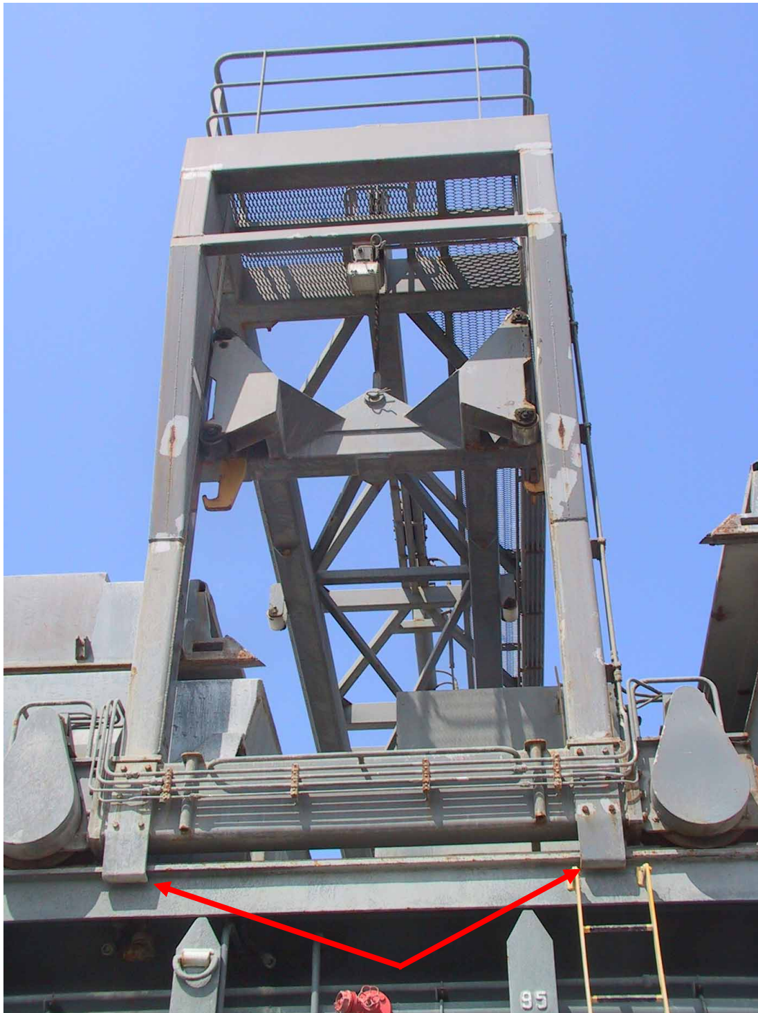
Kuva 10. Varmistussalvoilla varustettu nosturi. Punaiset nuolet osoittavat varmistussalvat.
