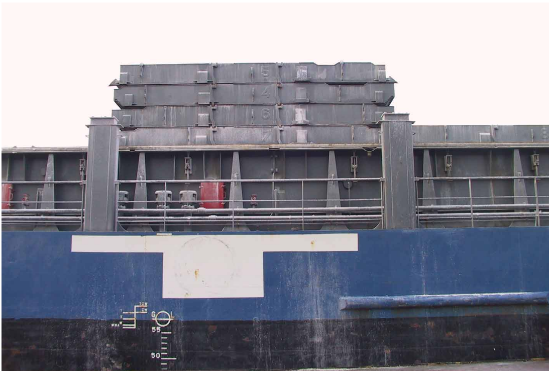
Kuva 9. Kansiluukkuja pinottuna, nostotaskut ovat merkitsemättä.
