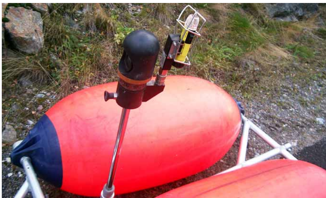
Kuva 3. KUHA 26:n vanavedessä hinattava kannatinkoho, jossa mukana vilkkuva, joka puolelle näkyvä valo.
