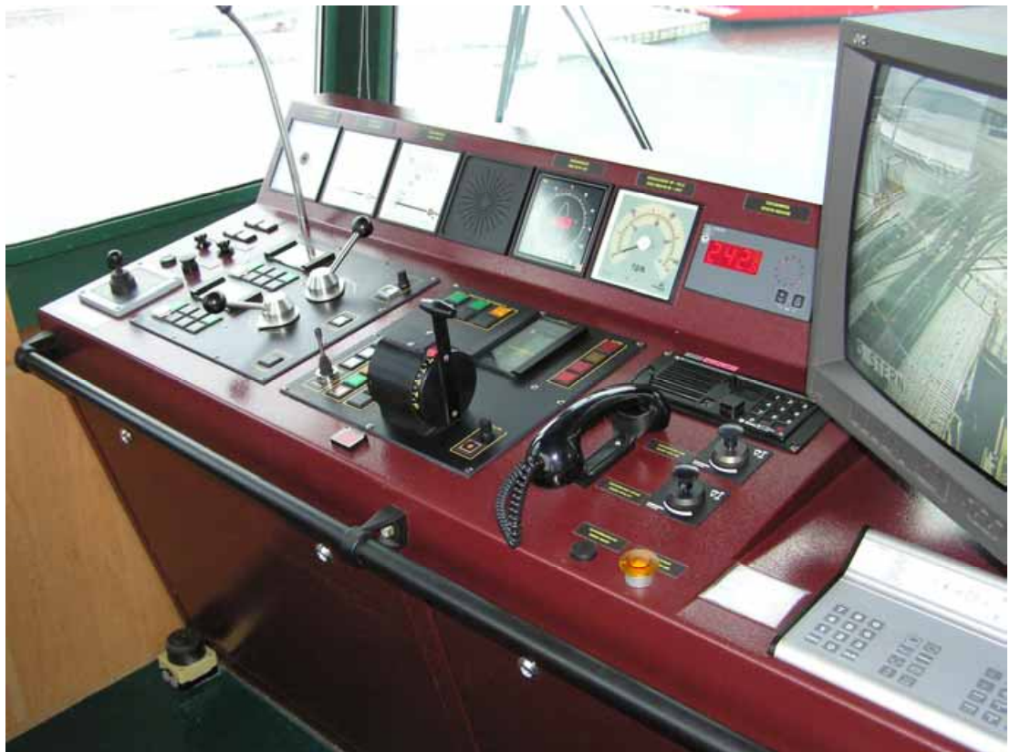
Kuva 3. Komentosillan vasemman siiven laitekonsoli.
