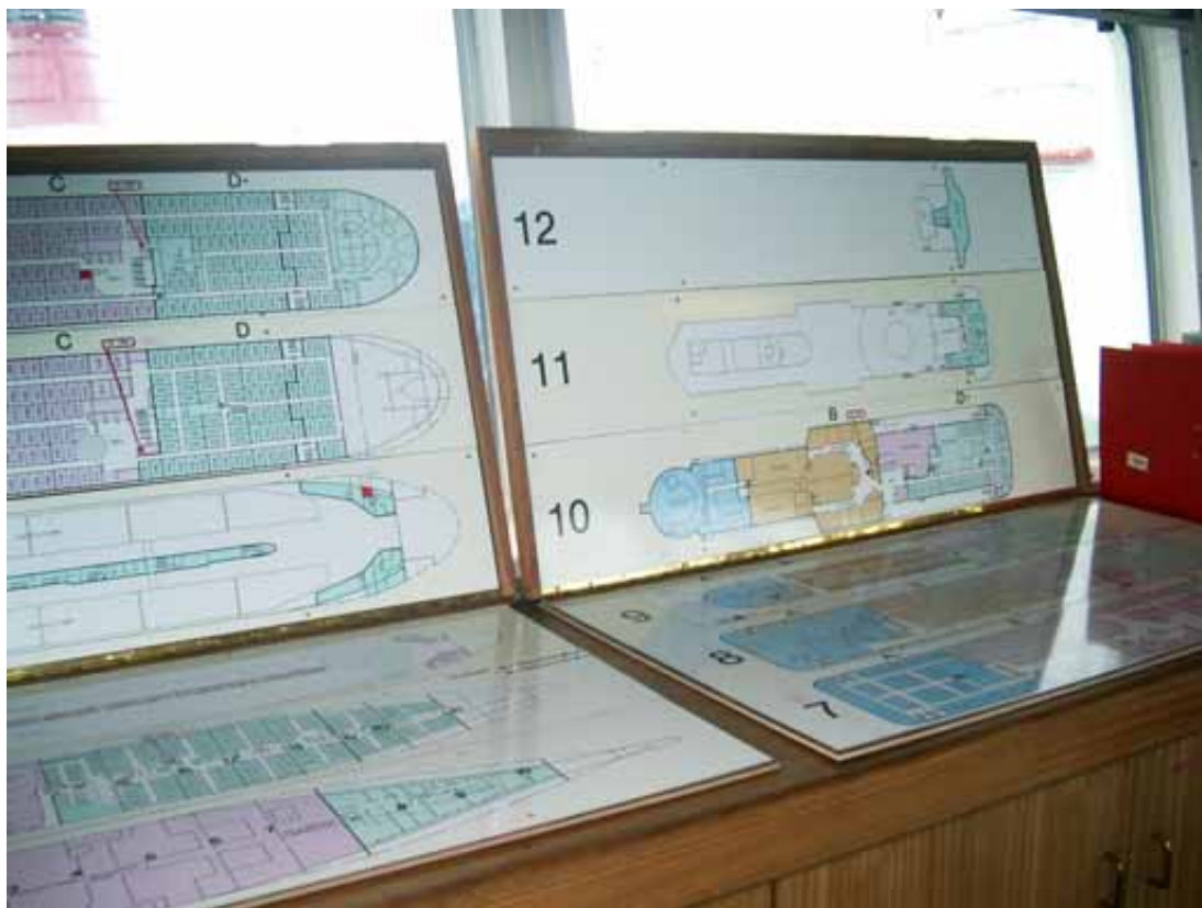
Kuva 3. Komentosillan johtopaikalla olevat aluksen kansien piirustukset.
