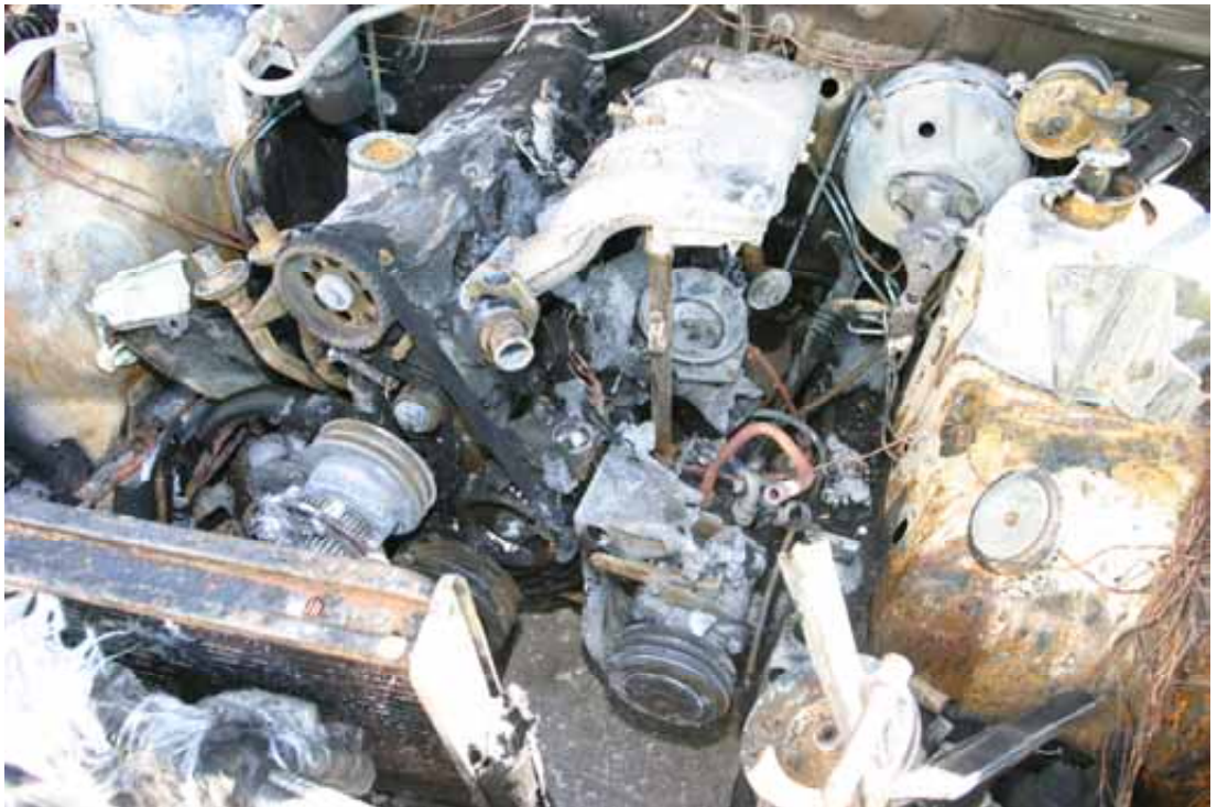
Kuva 10. Auton palanut konetila.
