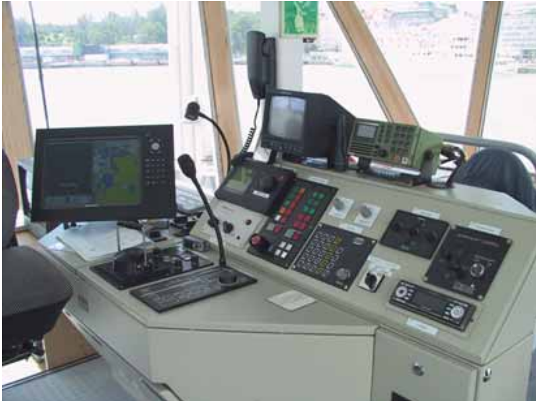
Kuva 4. Aluksen hallintalaitteita. Päällikön istuimen vieressä oleva kahva on ruoripotkuriyksikön hallintakahva. Istuimen toisella puolella on samanlainen kahva toista ruoripotkuria varten.
