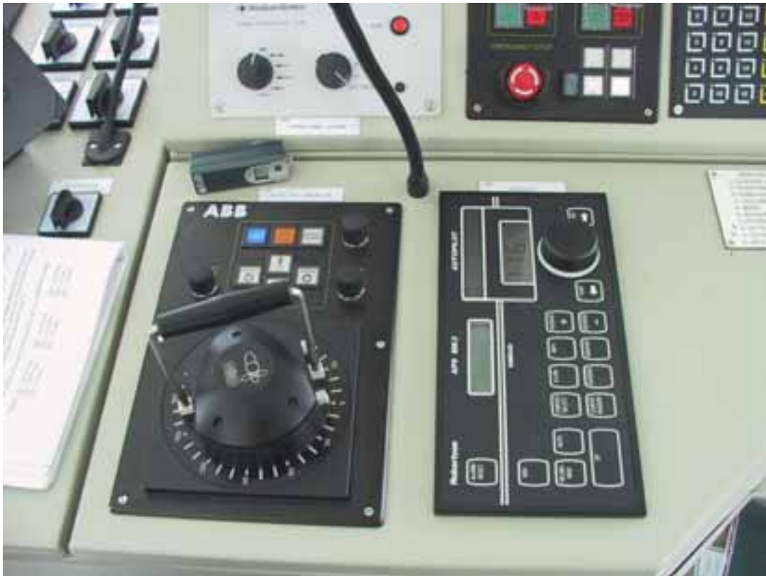
Kuva 6. Ruoripotkuriyksikön hallintakahva ja automaattiohjaus. Vastaavat ohjaukseen käytettävät laitteet ovat myös päällikön istuimen toisella puolella. Sininen merkkivalo hallintakahvan vieressä osoittaa, että käsiohjaus on käytössä. Valkoinen merkkivalo palaa silloin, kun automaattiohjaus on kytketty.
