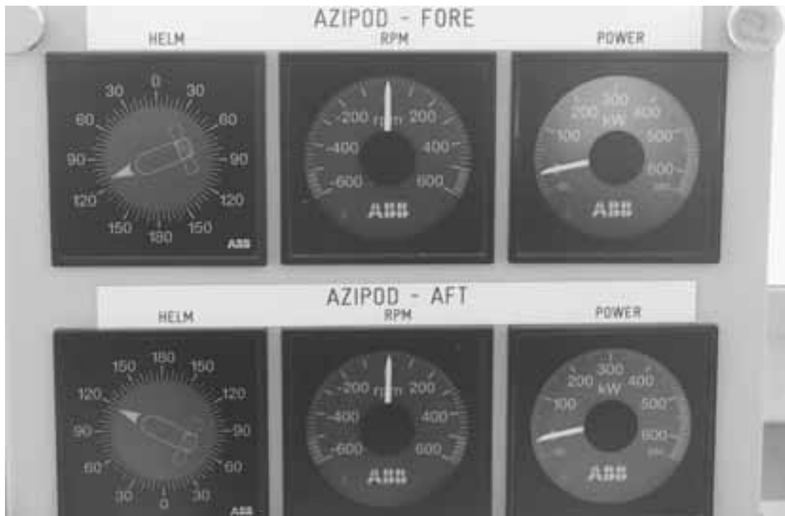
Kuva 5. Komentosillan ikkunan alareunassa olevat ruoripotkurien suunnan, kierrosnopeuden ja tehon osoittavat mittarit.
