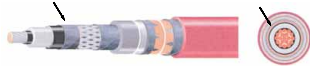
Kuva 10. Kaapelin rakenne. Eristyksen verhouksena oleva puolijohtava hohtosuoja on osoitettu nuolella. Aluksen kaapelin poikkileikkauksen mittasuhteet poikkeavat kuvassa esitetystä. Johtimen halkaisija oli noin 15 mm ja koko kaapelin halkaisija noin 36 mm.
