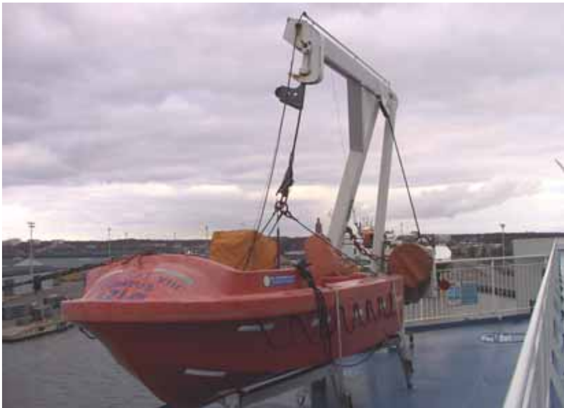
Kuva 2. MOB-vene, nostotaavetti ja nostokoukku. Taavestista tulee nostovaijerin li-säksi veneen akun latauskaapeli tukivaijereineen.
