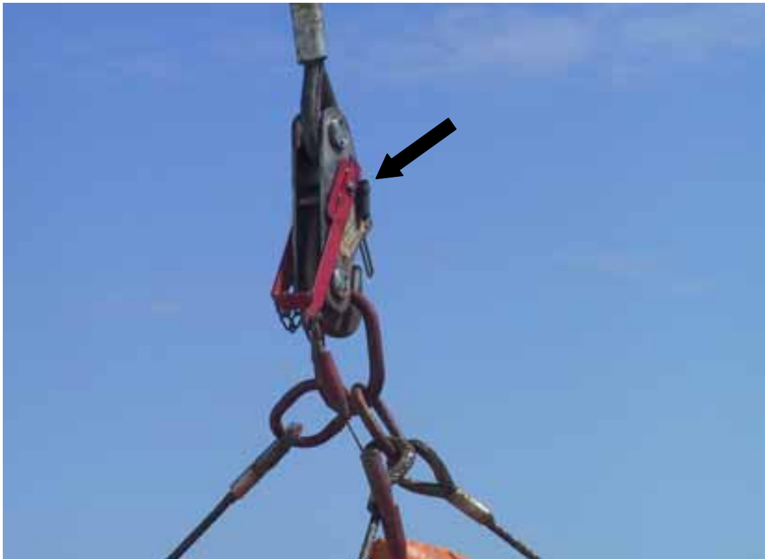
Kuva 6. Sisaraluksen vastaavan veneen nostokoukkumekanismi, jossa nuoli osoittaa alkuperäistä varmistustappia. Laukaisuvaijerin ympärillä olevat punaiset muovikartiot ovat tässä oikein eli kartiomainen pää alaspäin. Onnettomuudessa olleessa koukussa kartio osoitti ylöspäin, jolloin laukaisu oli hieman hankalampaa.
