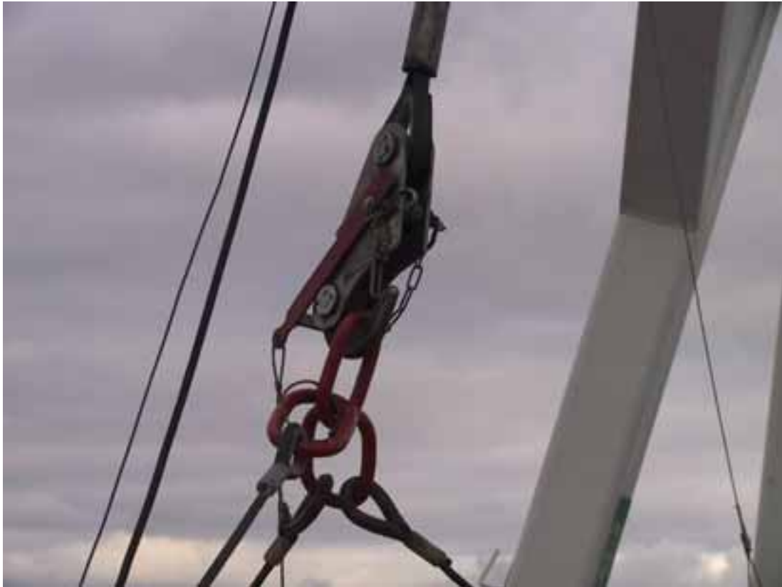
Kuva 4. Onnettomuusveneen koukku, jossa varmistustappina ollut pultti on paikoillaan. Laukaisuvaijeri lähtee laukaisuvivusta alaspäin. Veneen akun latauskaapeli ja sen tukivaijeri ovat vasemmalla.
