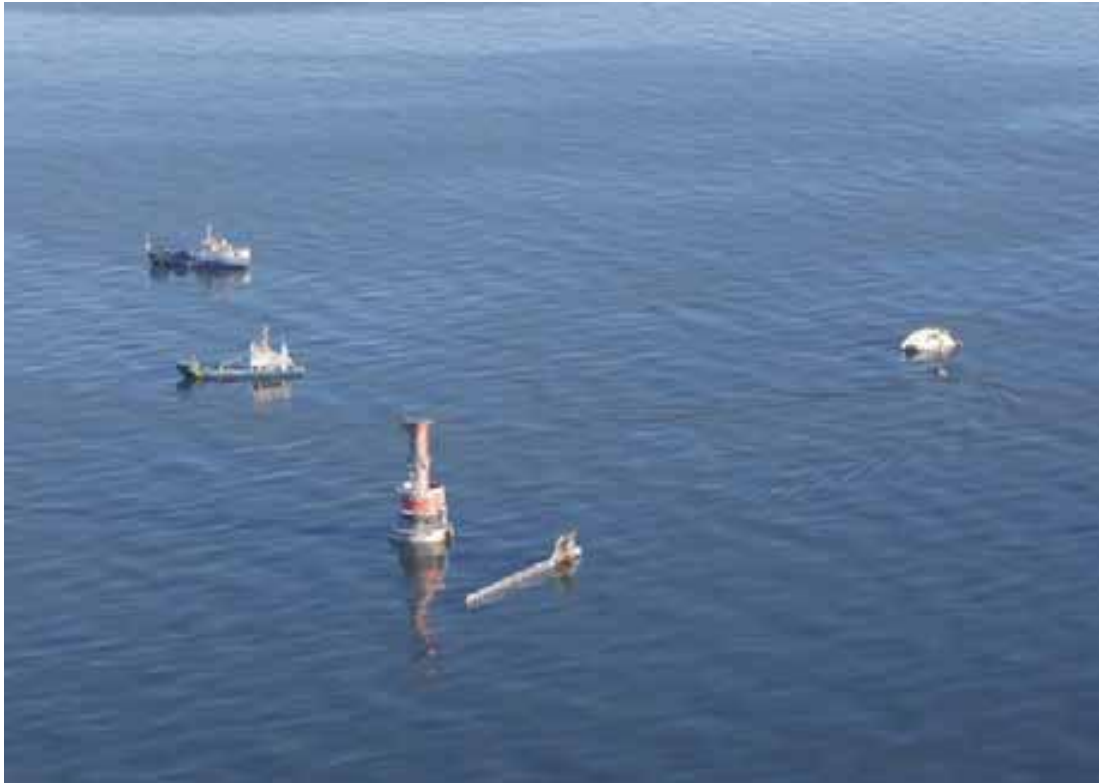
Kuva 6. Upponut yhdistelmä ja Grundkallenin majakka. Oikealla proomu BULKin keulakansi ja majakan vieressä proomun kylkirakenteita.
