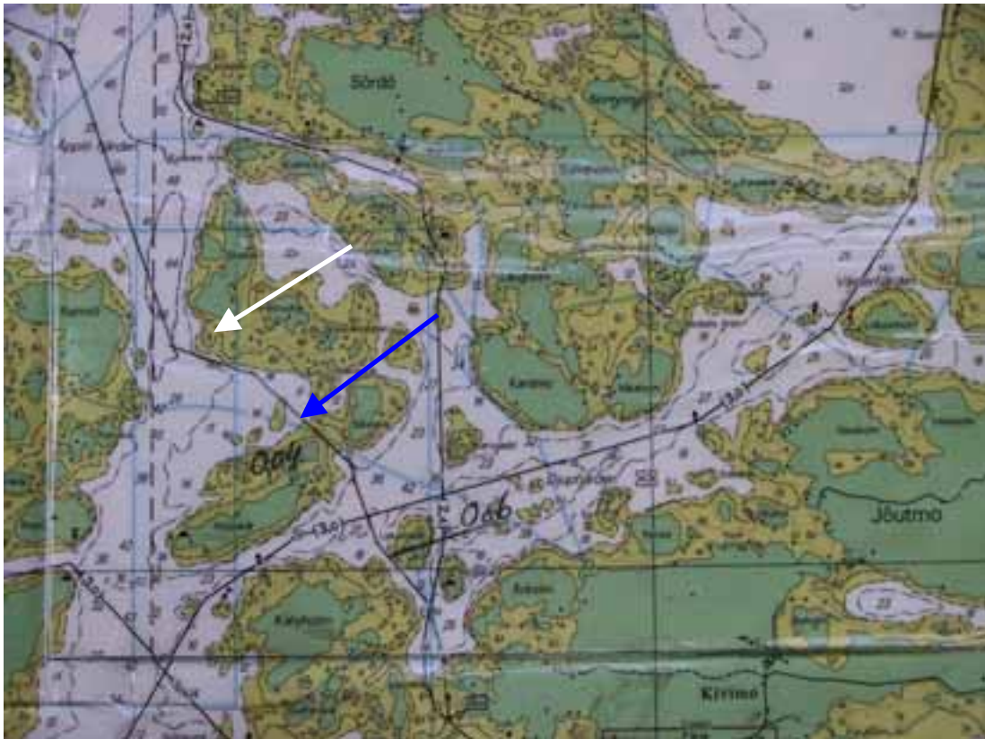
Kuva 4. KAROLINAN merikartta, valkoinen nuoli osoittaa karilleajopaikkaa, sininen nuoli osoittaa kurssiviivaa 314^\circ . (© Merenkulkulaitos)
