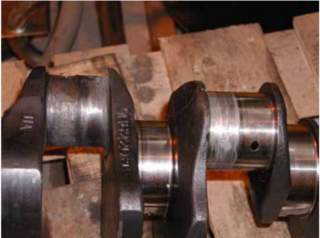
Kuva 2. Kiinnileikkautumisjälkiä koneen kampiakselissa.
