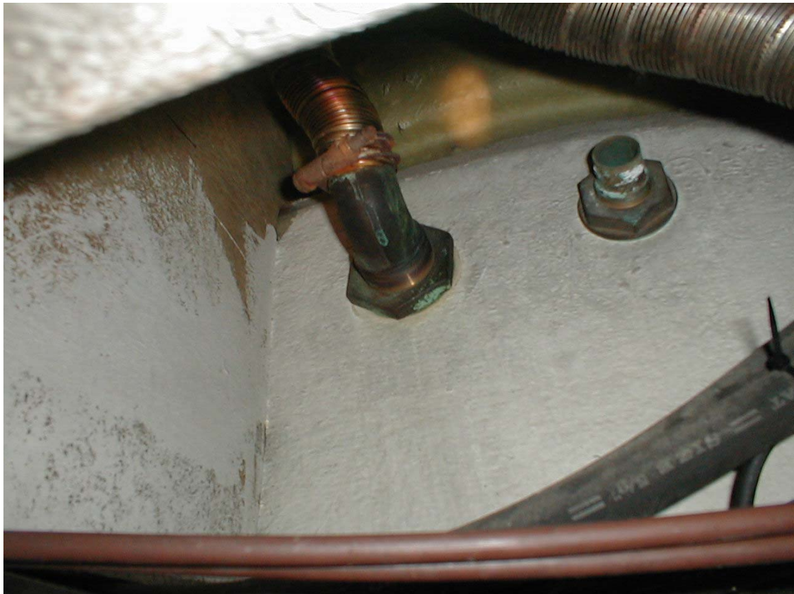
KUVA 6. Vapaa läpivienti ja lämmittimen pakoputki SB
