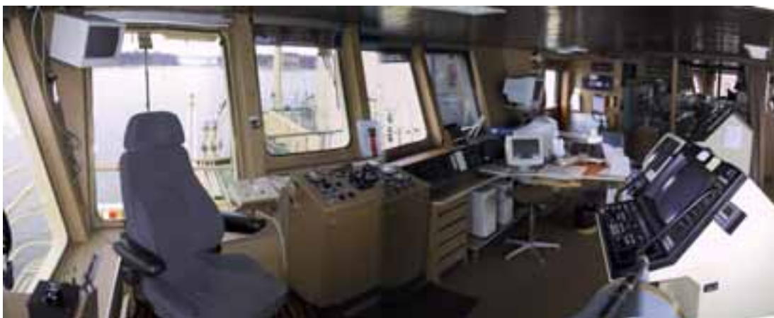
b) Etualalla vahtipäällikön työpiste, oikealla tutka ja vasemmalla hinausvinssin käyttökonsoli, näkymä on aluksen perään päin.
