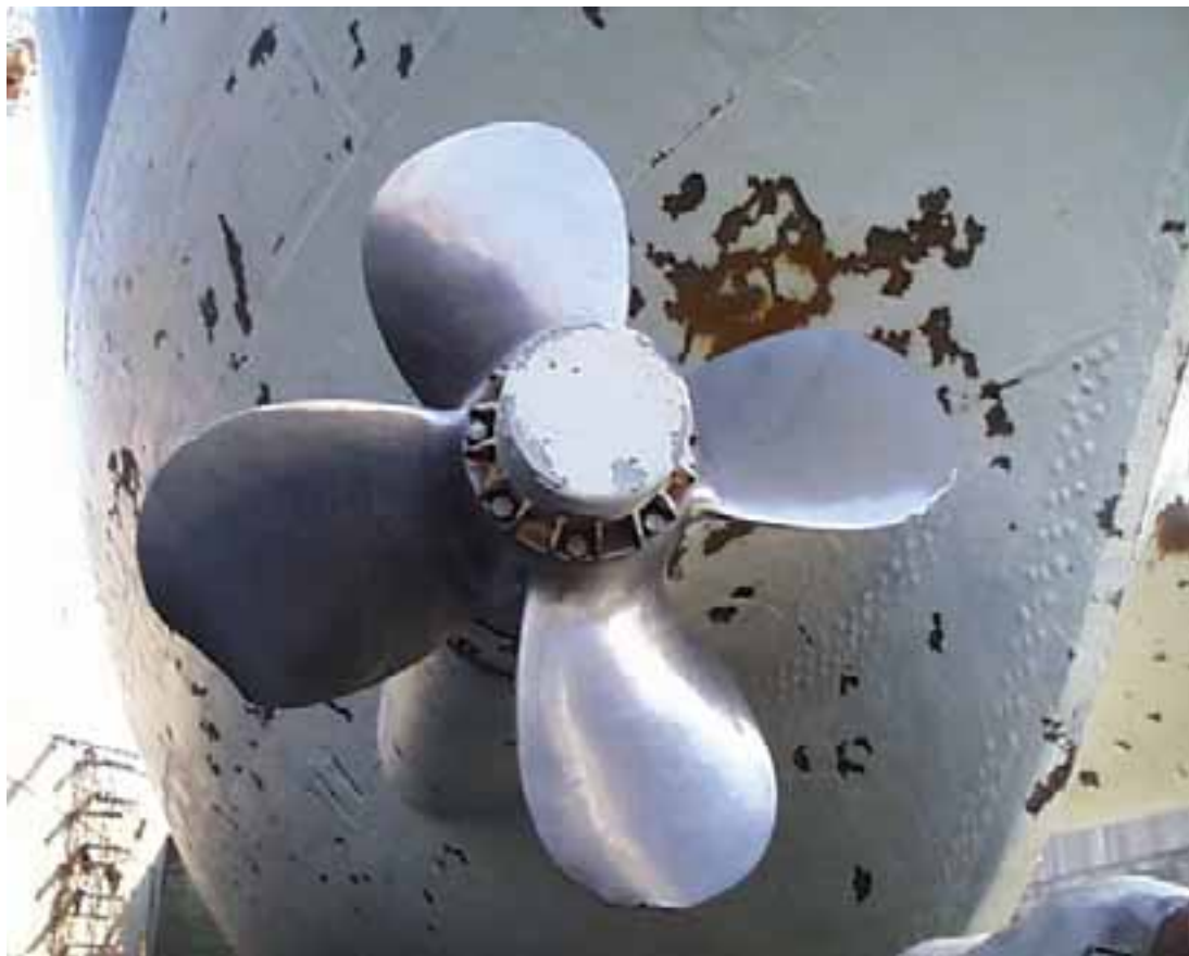
Kuva 15. Oikeanpuoleisen keulapotkurin vauriot.
