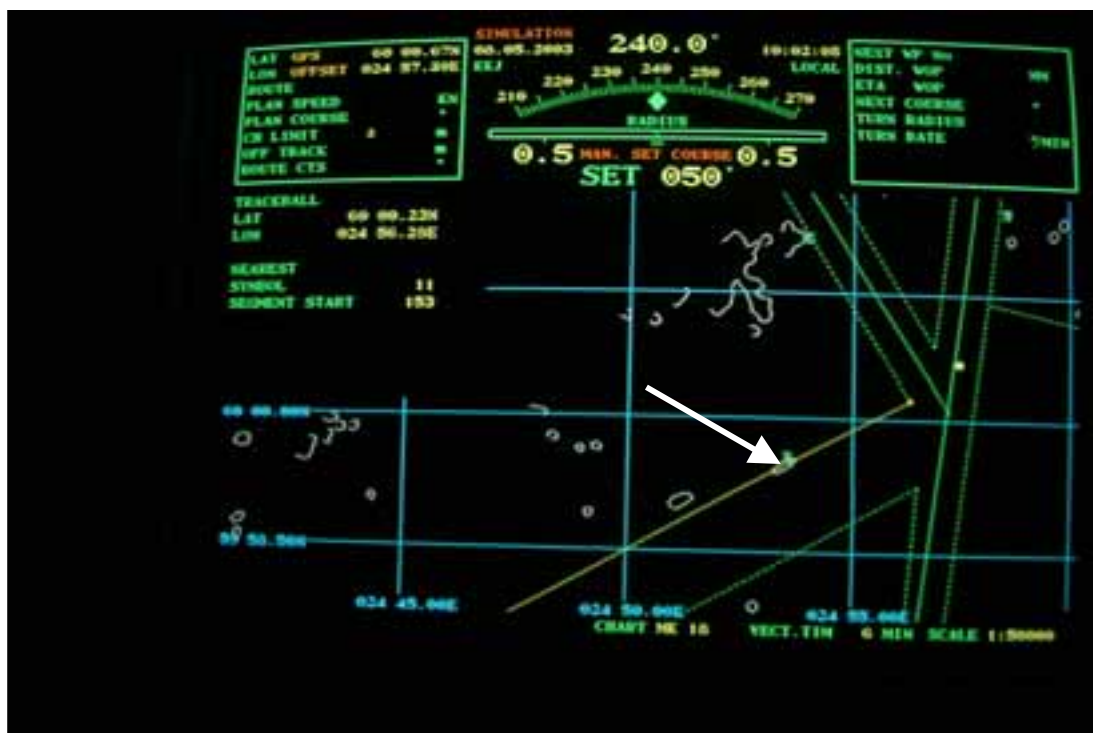
Kuva 17. VECTOR-näyttö syvyyskäyrien kanssa. Ulkomatala ja sen reunamerkki on nuolen kohdalla, reunamerkki on merkitty x:llä (myös kuvassa 16).
