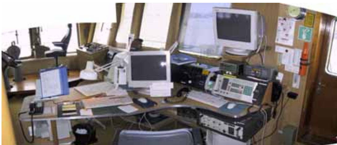
c) Navigointiperämiehen työpiste, paikka 8 kuvassa 4, oikealla osa radiolaitteista. Taustalla vahtipäällikön työpiste.
