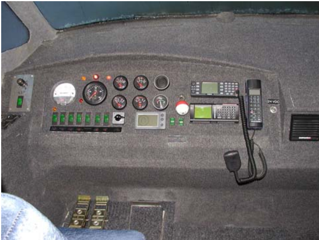
Kuva 2. JK-135 ohjauspaikka, joystick-ohjain vasemmalla sivulla ei näy kuvassa.
