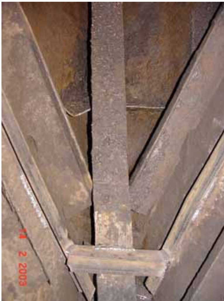
Kuva 3. Kuva keulapiikistä. Kuvan keskellä keulan 1. kaari. Puoliskot ulottuvat köli-rautaan saakka, mutta liitoskohdista näkyy selvästi, että kaaria ei ole hitsattu kiinni kölirautaan. Kuvan alaosassa 1. uusi kaari ja sen kölirautaan hitsattu poikittaisjäykkäjä.
