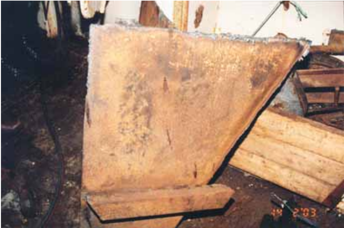
Kuva 2. Törmäyslaipion oikealta kyljeltä irti leikattu osa. Taipuma näkyy kappaleen oikeassa reunassa. Taipuman kohdalla laipio on irronnut vaakasuorasta jäykkäjästä.
