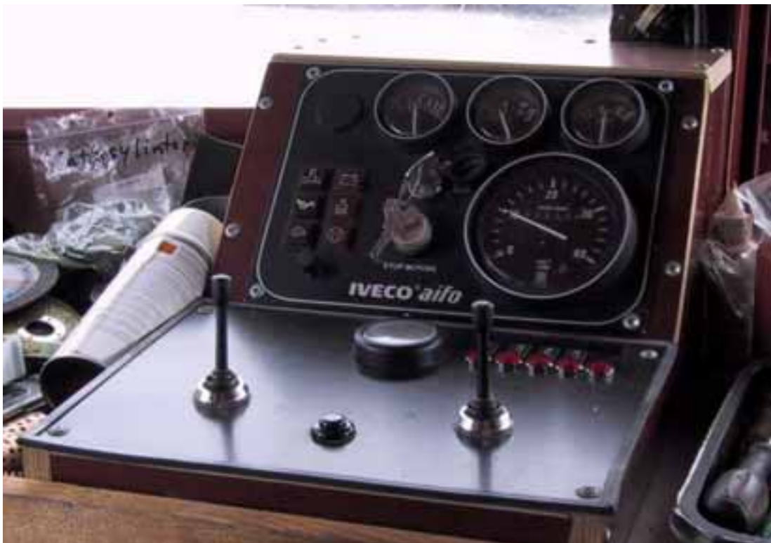
Kuva 5. PUSKUn ohjauskonsoli. Huomaa NFU-vivut. Iso mittaritaulu näyttää pääkoneen kierrosluvun.
