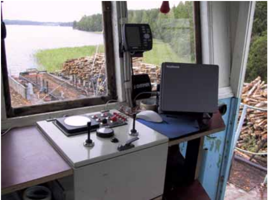
Kuva 6. Proomu PÖLLI 7:n ohjaamon toisio-ohjauspaikka, joka sijaitsee poikittais-suunnassa aluksen keskellä. Huomaa NFU-vivut.
