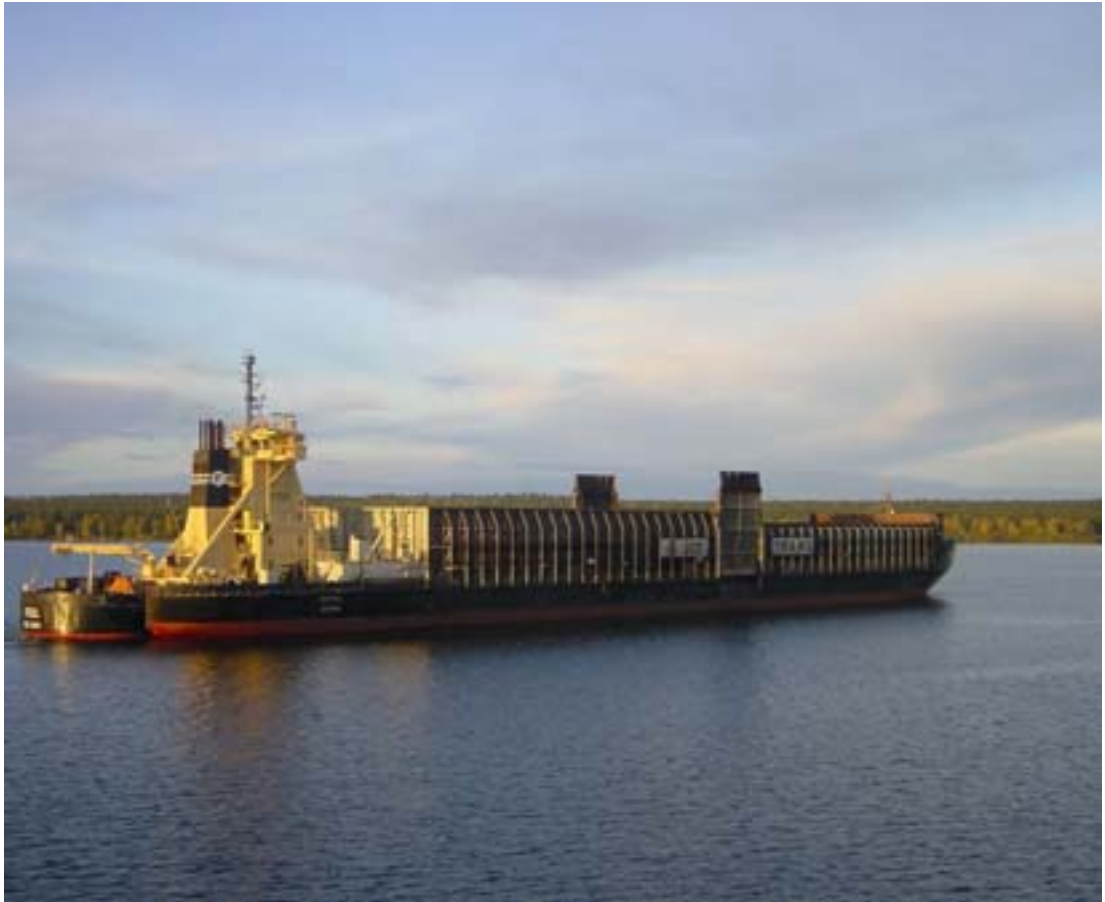
Kuva 1. Puskuhinaaja STEEL kiinnittyneenä proomuun. (© ESL-Shipping)
