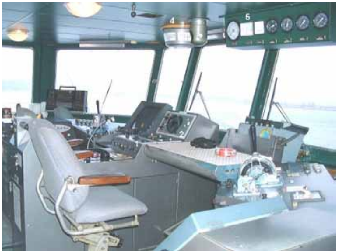
Kuva 7. Kuva otettu komentosillan oikealta sivulta. Luotsin ohjailupaikka vasemmalla puolella. Numero 1. NFU-vipu, 2. kompassinäyttö, 3. konetehon ohjailu, 4. peräsinkulman näyttö ja 5. kulmanopeusmittari.
