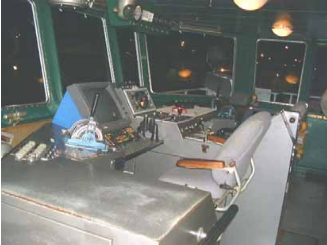
Kuva 8. Luotsin käyttämä ohjauspaikka vasemmalta kuvattuna. Peräsinkulman osoitin näkyy vain osittain tutkanäytön yläpuolella.
