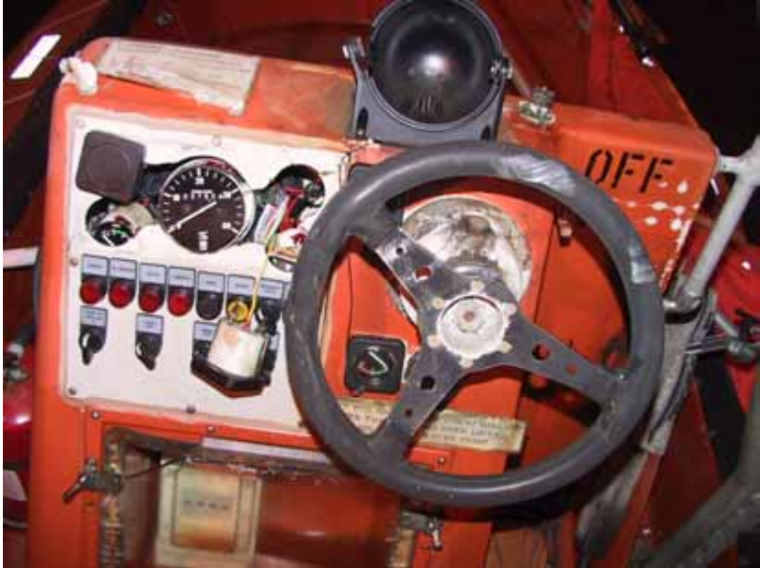
Kuva 3. MOB-vene en vaurioituneet ohjauslaitteet.
