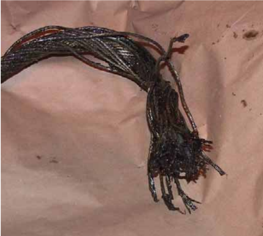
Kuva 8. Vaijerin pään säikeissä ei ole venymää vaan ne ovat kaikki yhtä pitkiä.
