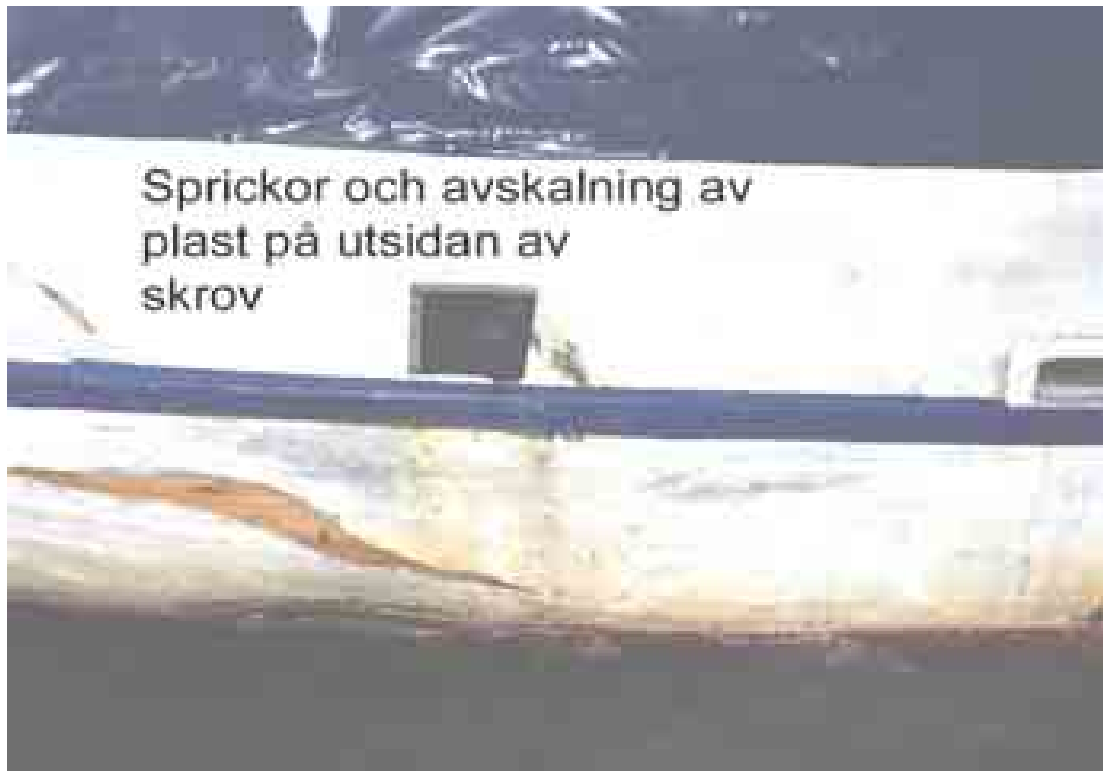
Kuva 3. SARAN vasemman kyljen vaurioita.
