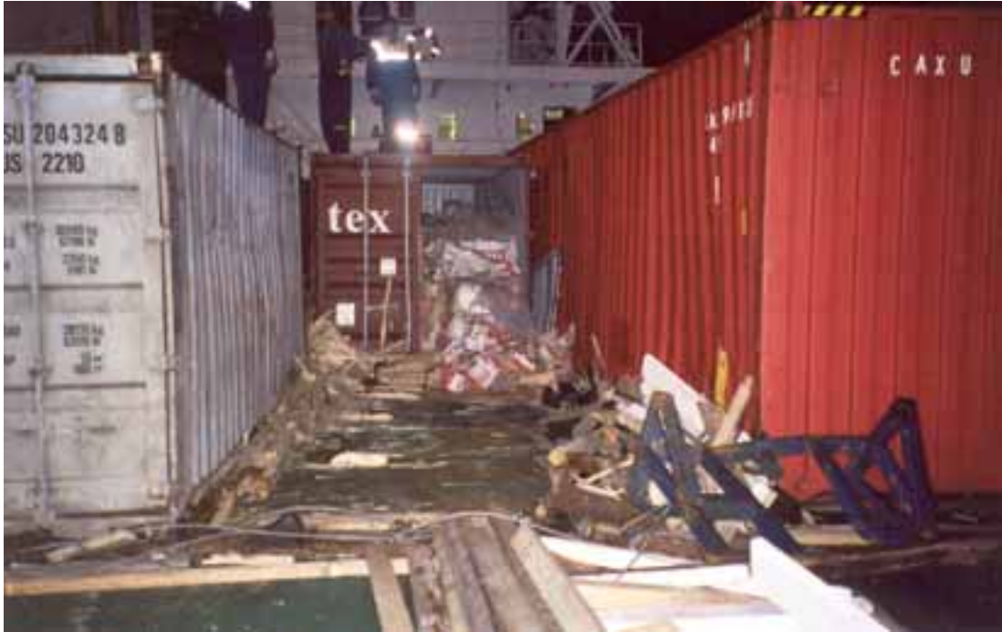
Kuva 16. Sääkannen vaurioituneita kontteja.
