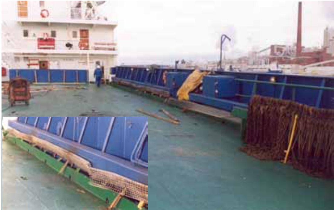
Kuva 14. TRADENin vahingoittunut lehmänsilta sääkannella.
