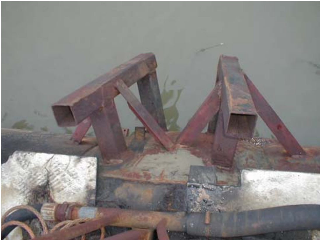
Kuva 4b. Ponttonilautan kiinnityshaarukka puskuhinausta varten.
