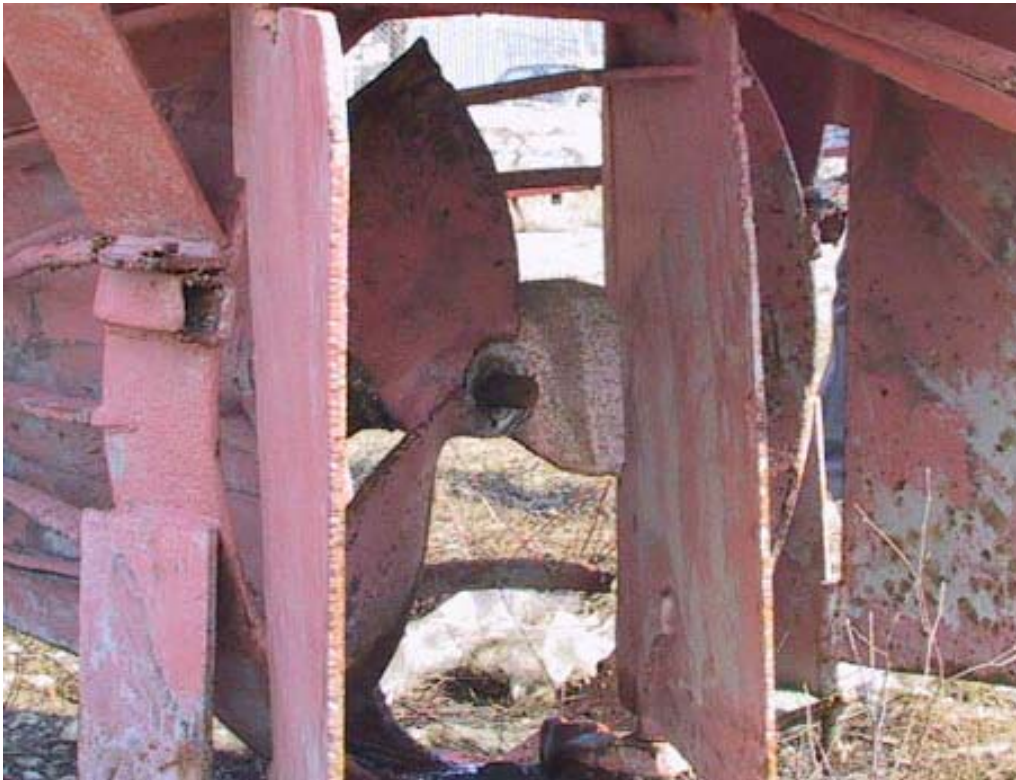
Kuva 7. Potkuri, sen suojahäkki ja kolmoisperäsän.
