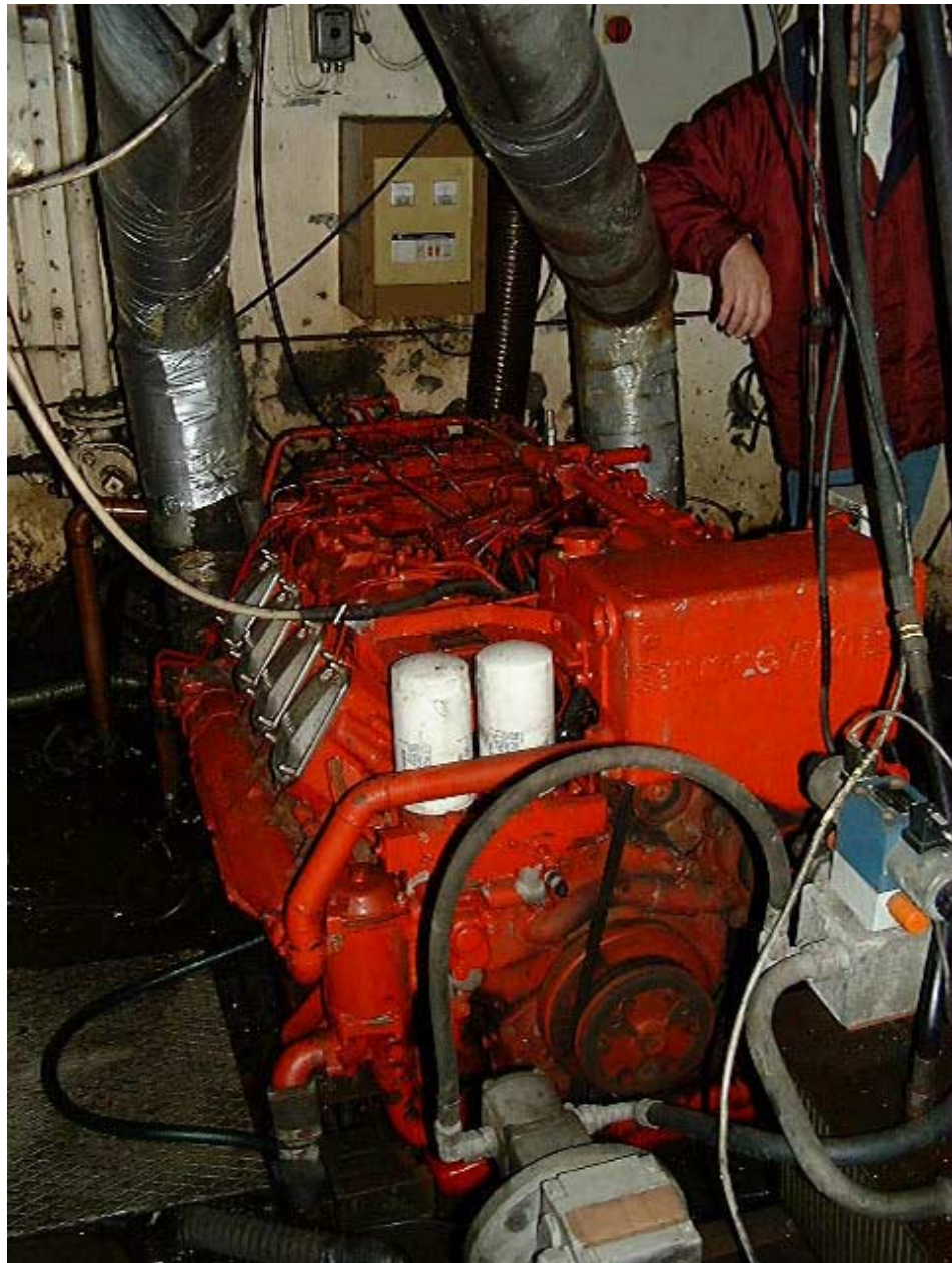
Kuva 11. RANDÖn pääkone 13.2.2001. Pakoputkien eristetyt alkupäät näkyvissä.
