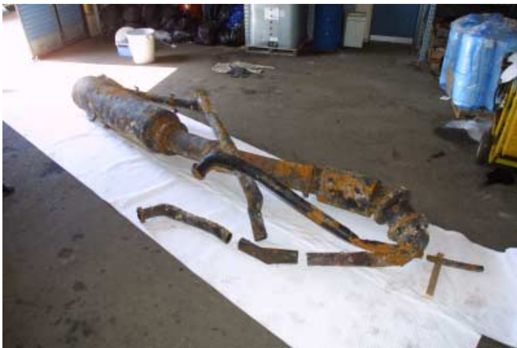
Kuva 7. Merestä nostetut RANDÖn pakoputkiston osat. Kuvaushetkellä VTT:lle jatkotutkimuksiin toimitetut osat on jo irrotettu. Lämpökattilan savuhormin alkupää puuttuu kuvasta (oli ristikkäin pakoputkesta irrotetun mutkan kanssa). Apukoneen pakoputkesta näkyy vain loppupää ennen liitosta pääpakoputkeen.
