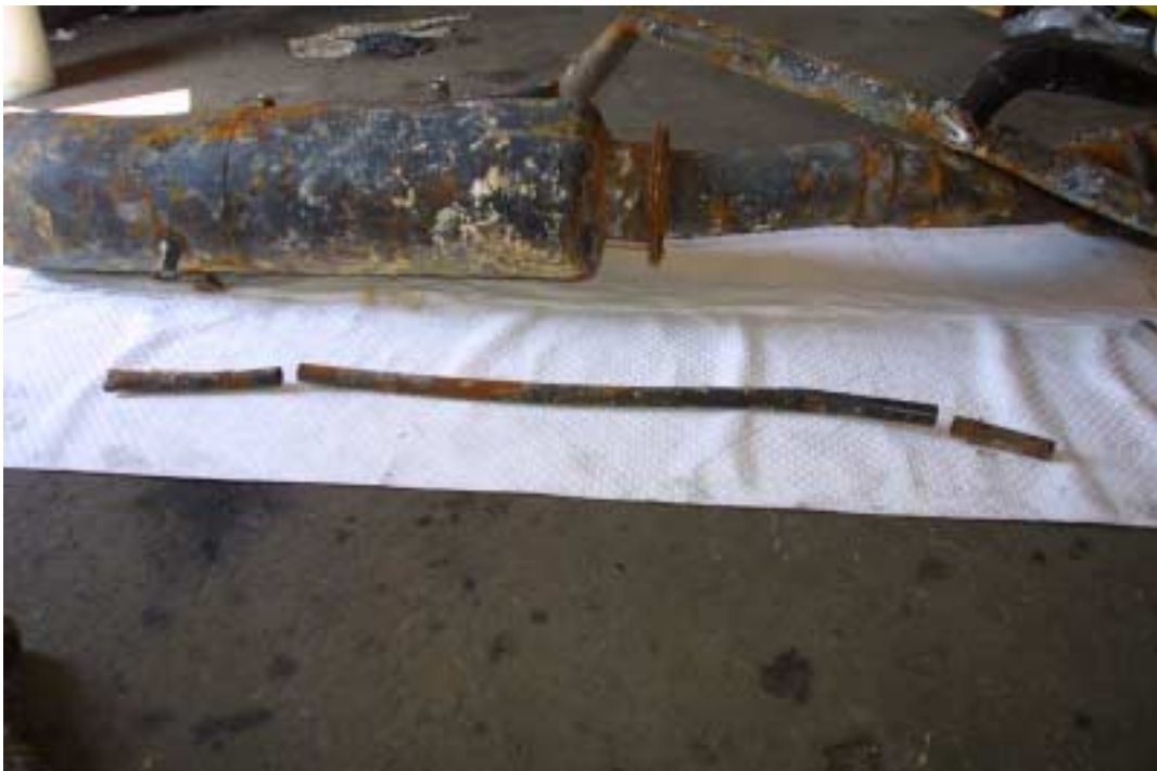
Kuva 9. Apukoneen pakoputki etualalla. Vasemmalla liitoskohta pääpakoputkeen, oikealla liitoskohta apukoneen lähellä olleeseen joustavaan osaan.
