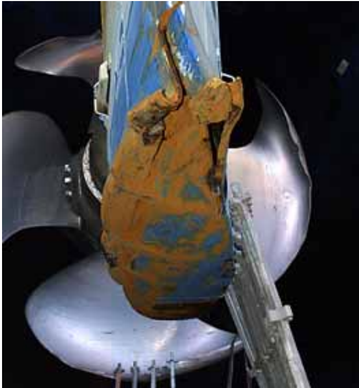
Kuva 21. Potkurin ja peräsimen vaurioita.
