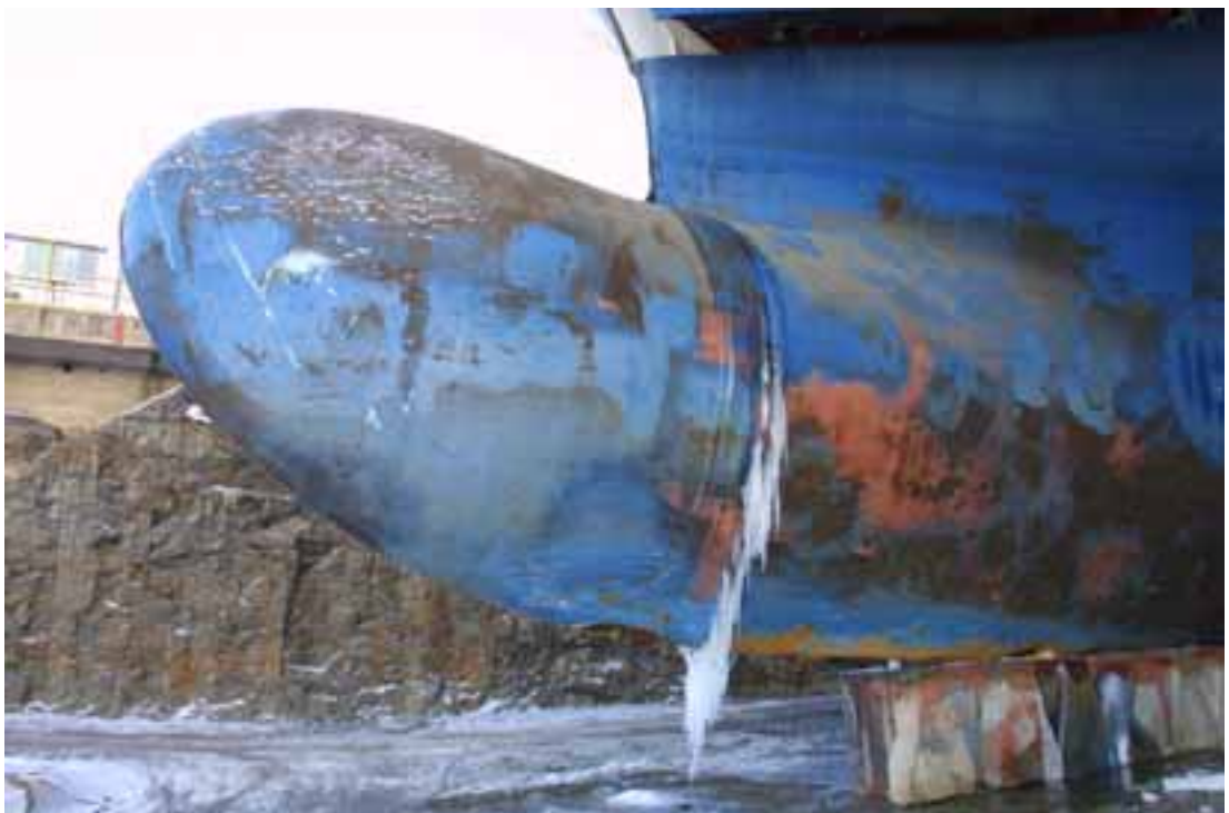
Kuva 20. Bulbin alareunasta repeytyi kappale
