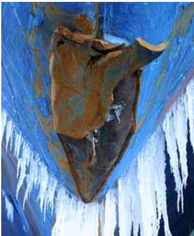
Kuva 22. Instrumenttibulbissa olleet anturit rikkoutuivat.
