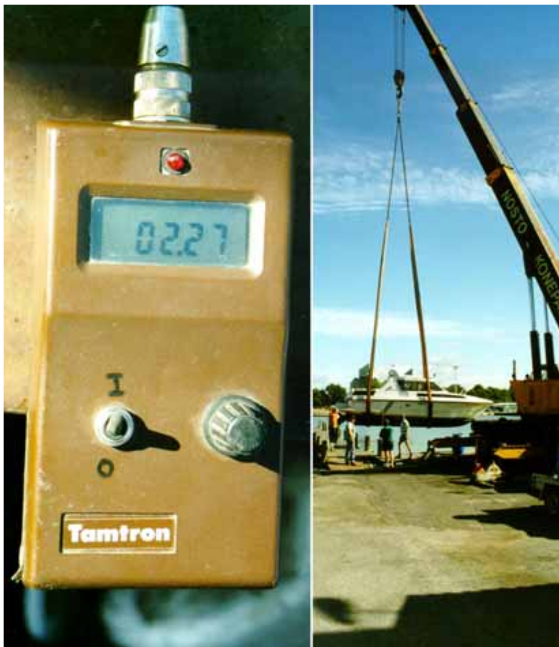
Kuva 1. Koevene punnittiin ja sen painopiste määritettiin nostoliinojen geometrian perusteella.
