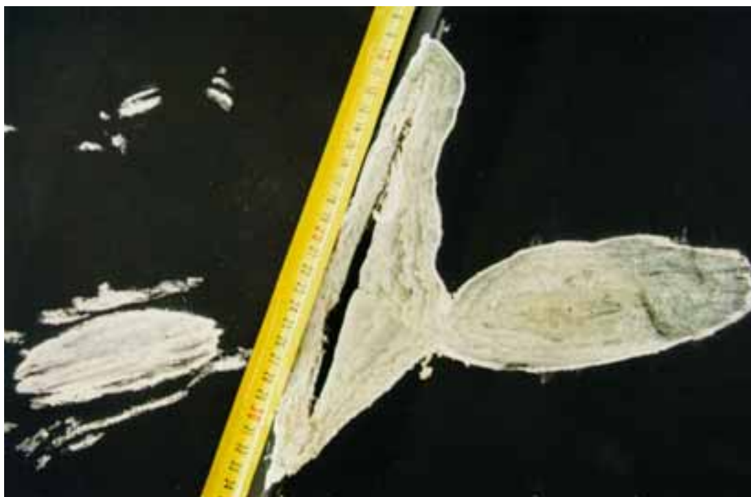
Kuva 7. Onnettomuusveneeseen pohjaan veneen upoksissa ollessa syntynyt reikä
