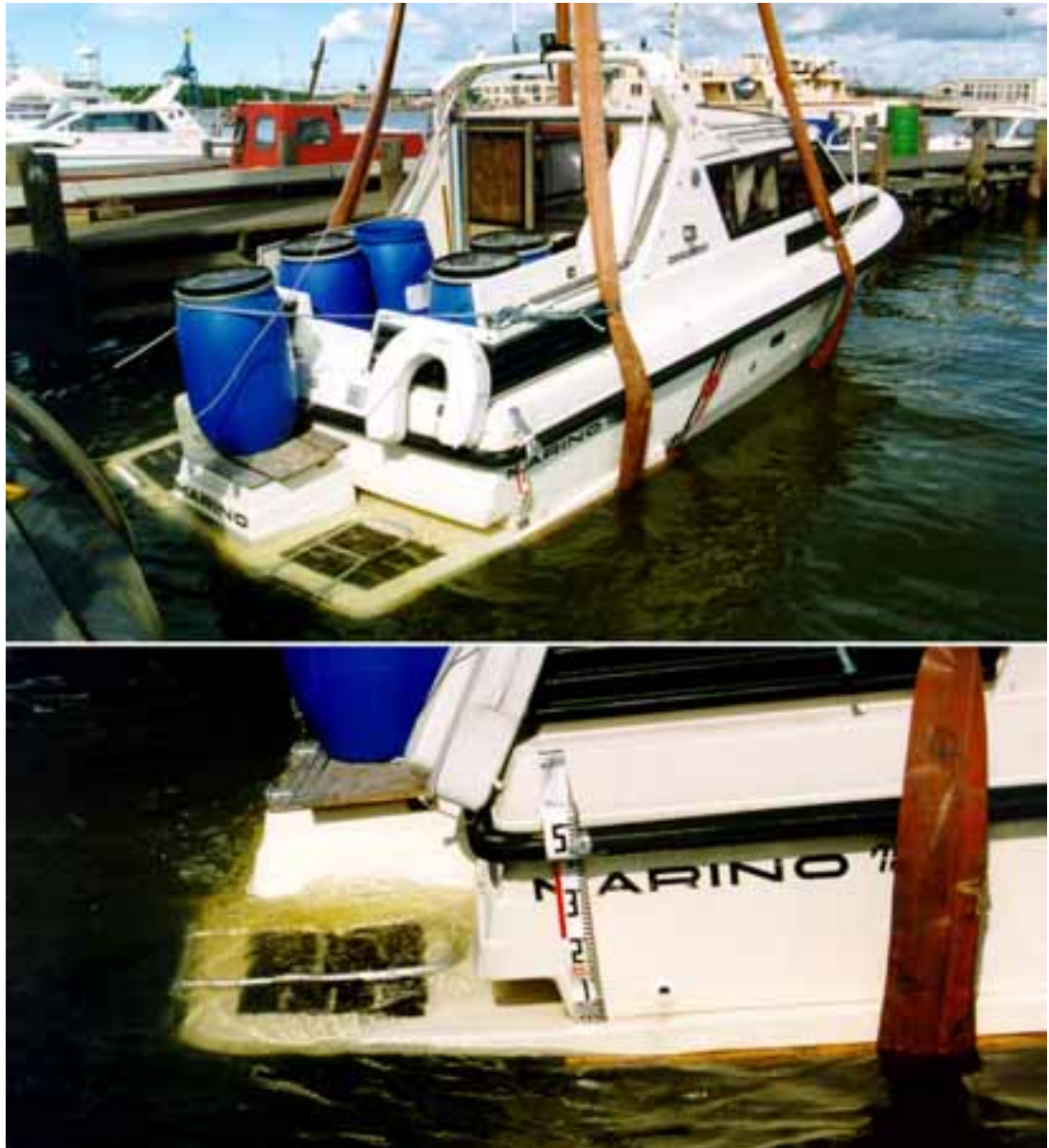
Kuva 5. Tässä kuvassa on henkilöiden painoa vastaava paino siirretty keulahyttiin kuvaamaan tilannetta, jossa seurue painopistettä siirtämällä olisi yrittänyt saada vuodon hallintaa. Voidaan todeta, että vallinneissa aallokko-olosuhteissa aluksen pelastaminen ei enää havaitussa vesikuormassa olisi ollut mahdollista.
