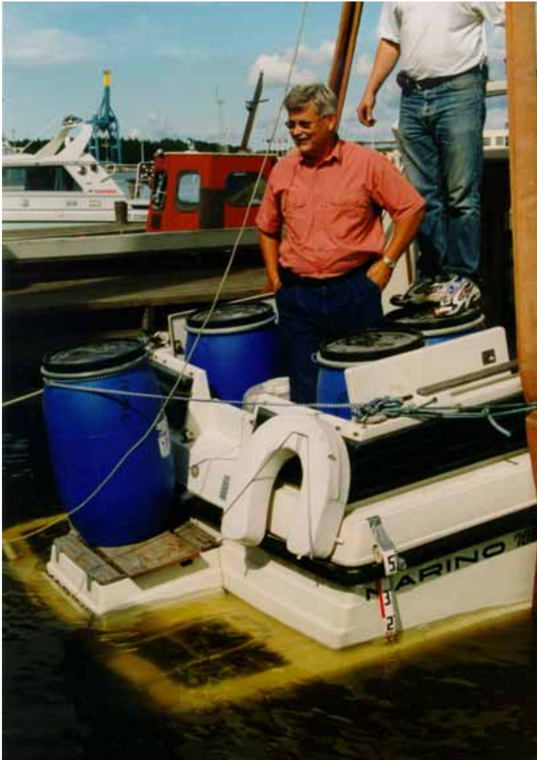
Kuva 4. Avotilaan lisätyillä painoilla tilanne, jossa veneessä on 350 litraa vettä, jonka jälkeen vesi voidaan havaita ohjaamon lattialla. Seurue on kokoontuneena katsomaan sukeltajan menoa veteen ja yksi seurueen jäsenistä havaitsee veden tulevan alukseen. Kuvan henkilöt eivät liity onnettomuuteen. Tällöin tyynessä vedessä varalaita on vähentynyt 20–30 mm:iin. Vallinneissa aal- lokko-olosuhteissa veden vuotaminen lienee ollut jo lähes jatkuva.
