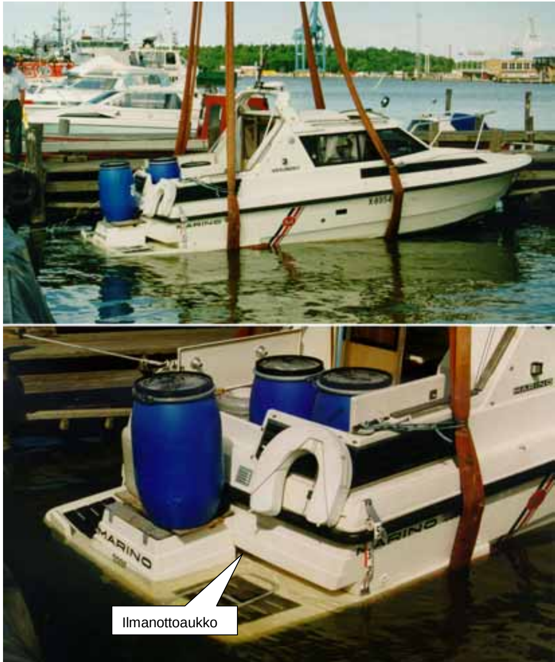
Kuva 3. Seuraavaksi painot sijoitettiin siten, että ne vastasivat ensimmäisen sukeltajan veteen menovaihetta; ohjaajan paikalle 80 kg, keulahytettiin 60 kg, pistopunkkaan 60 kg, perän avotilaan 300 kg vastaten kolmea seurueen jäsentä ja avotilassa ollutta materiaalia ja ankkuriboksin päälle 100 kg vastaten sukeltamaan menevää henkilöä varusteineen. Tällaisessa asennossa vene keinui poijuun kiinnitettynä uppoamispaikallaan ilman ylimääräistä vesilastia konetilassa. Tässä kuormausstilanteessa varalaitaa on enintään 70 mm.
