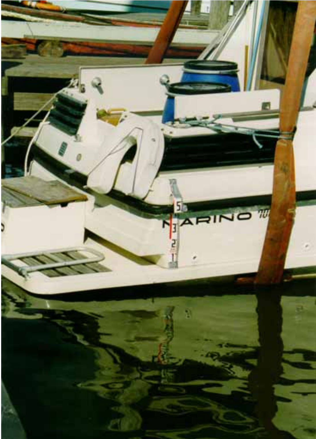
Kuva 2. Painoja lisättiin siirtymismatkan aikana ilmoitettuihin henkilöiden ja kuorman sijoituspaikkoihin; perän avotilaan oikealle puolelle 80 kg ja vasemmalle 160 kg, keulahyttiin 60 kg, pistopunkkaan 80 kg, ohjaajan paikalle 80 kg, apu-ohjaajan paikalle 80 kg ja ohjaamon turkille 80 kg. Kuvassa veneen kellumisasento näin kuormitettuna. Näin voidaan todeta, että onnettomuusveeneen varalaita retkelle lähdettäessä on ollut enintään 250 mm.
