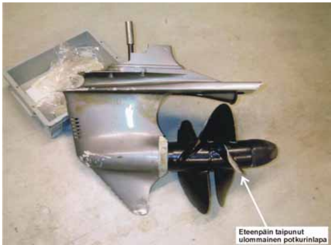
Kuva 3. Irronnut vetolaitteen alapää
