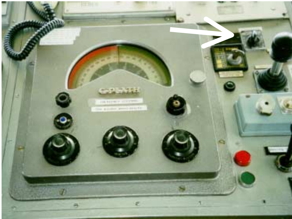
Kuva 12. Valokuva autopilotista. Vieressä autopilotin ja käsiohjauksen valintakytkin (merkitty nuolella).
