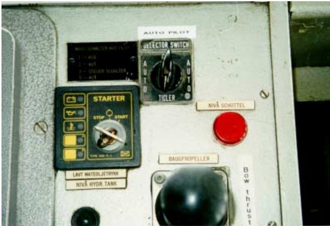
Kuva 14. Autopilotin ja käsiohjauksen valintakytkin.
