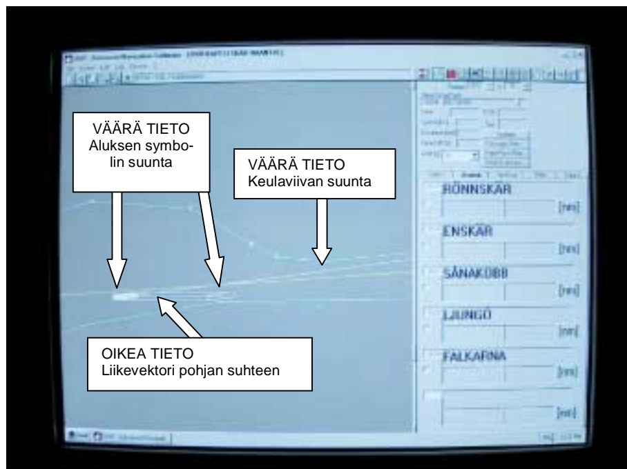
Kuva 25. ANS ohjelman näyttö 45 sekuntia kompassin jumiutumisen jälkeen. Kuva vastaa kuvien 23 ja 24 ajankohtaa.
