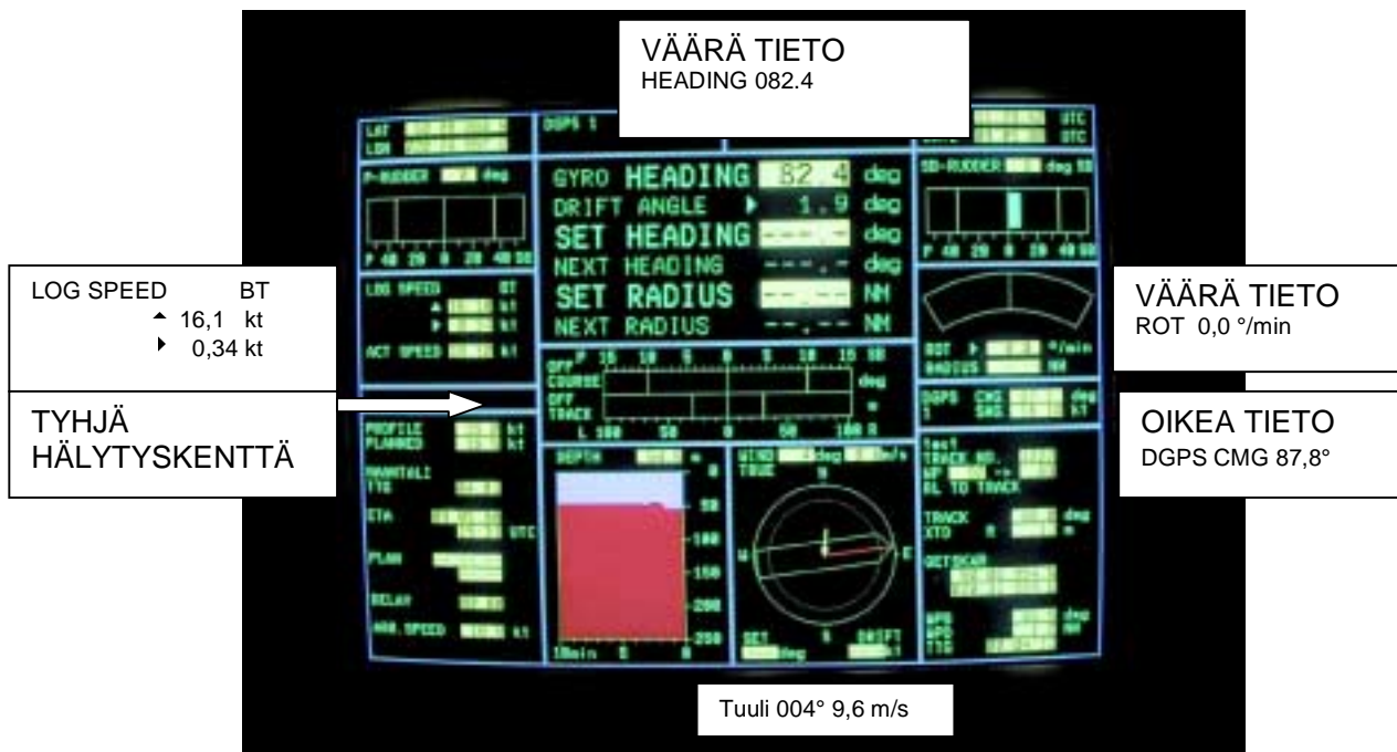
Kuva 22. Kompassi on ollut 30 sekuntia jumissa. Kuva vastaa tutkakuvan 21 tilannetta.
