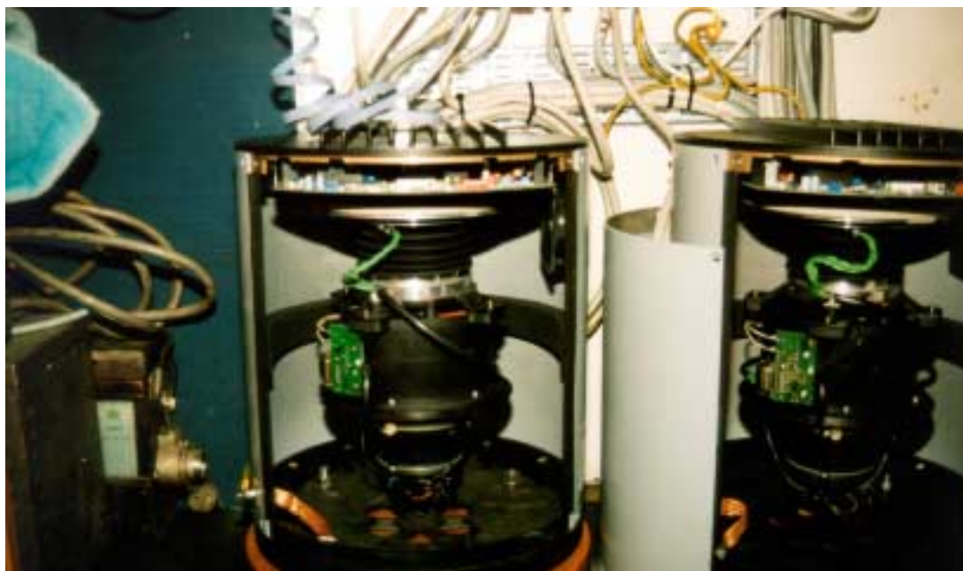
Kuva 12 FINNFELLOWin kompassiasennus kuvattuna testien yhteydessä telakalla karilleajon jälkeen. Vasemmanpuoleisen hyrräkompassin nro 1 takana näkyy vyyhdellä oleva signaalikaapeli.
