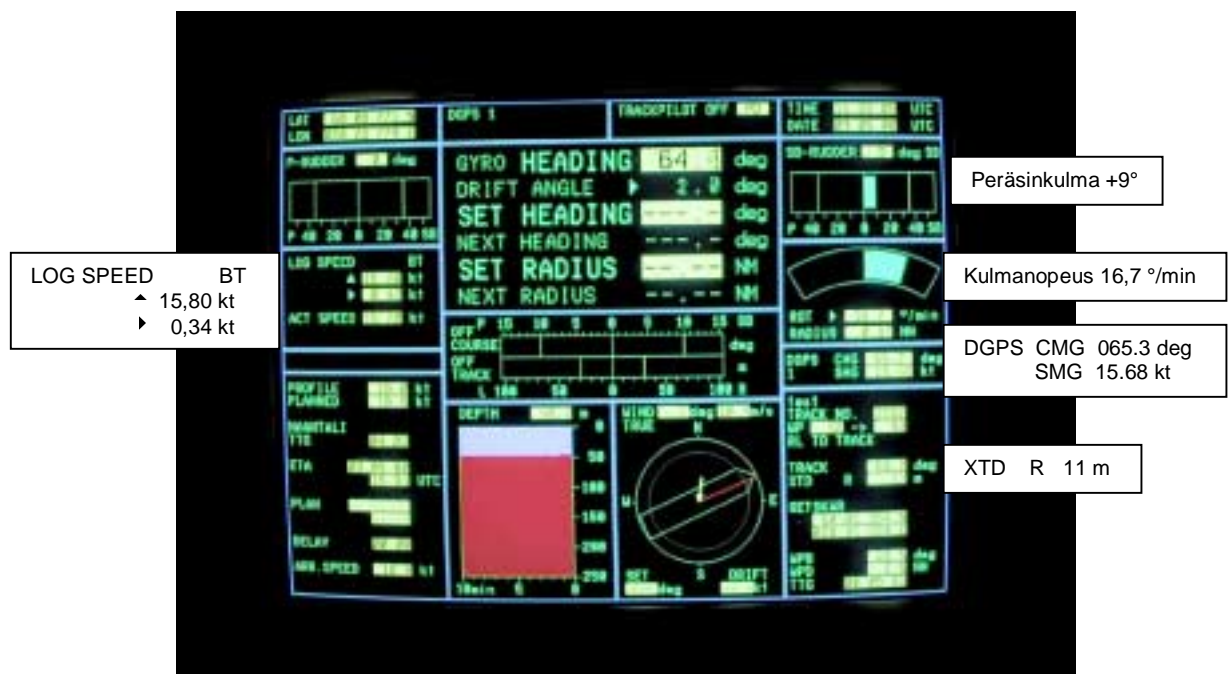
Kuva 18. Autopilotin näyttöruutu NCC. Kuva vastaa tutkakuvan 17 tilannetta.
