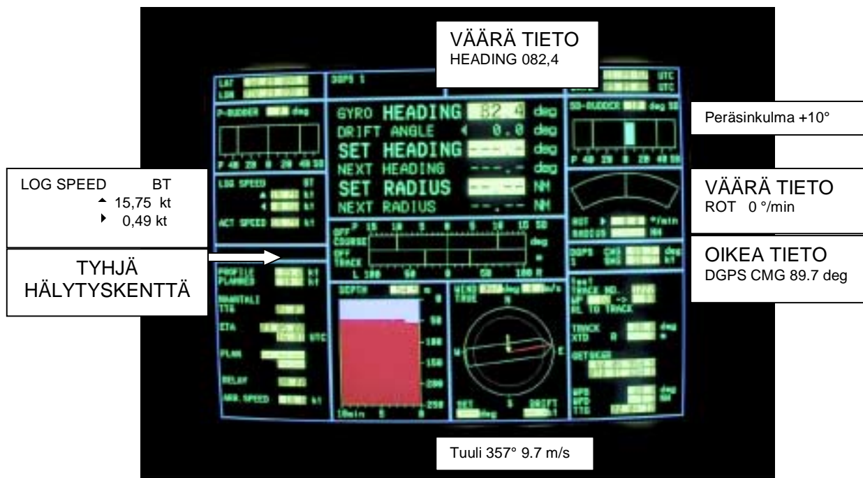
Kuva 24. Kompassi on ollut 45 sekuntia jumissa. Kuva vastaa tutkakuvaa 23.
