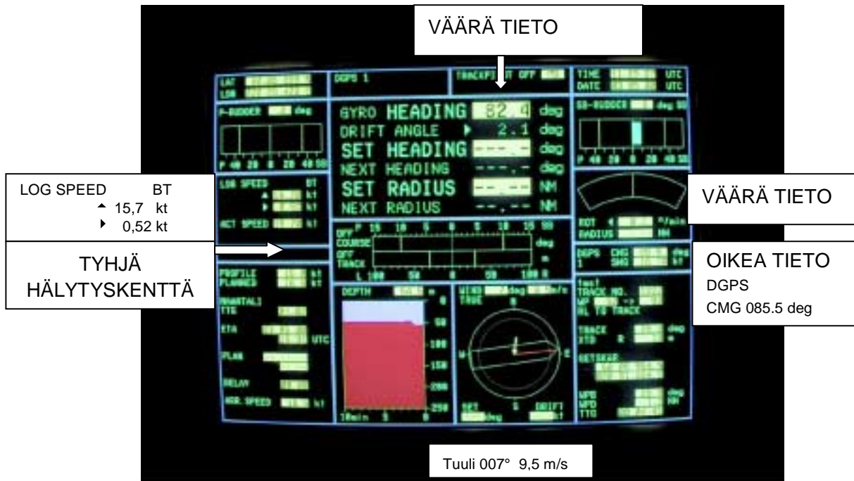
Kuva 20. Kompassi on ollut 15 sekuntia jumissa. Kuva vastaa tutkakuvan 19 tilannetta.
