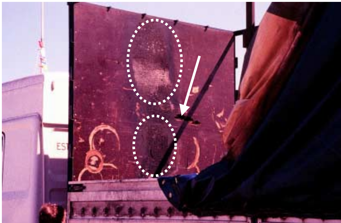
Kuva 3c. Perävaunun etuseinässä on havaittavissa kaksi vähäistä hiiltymäaluetta (katkoviivojen sisällä). Nuolen osoittamassa kohdassa on pieni reikä.
