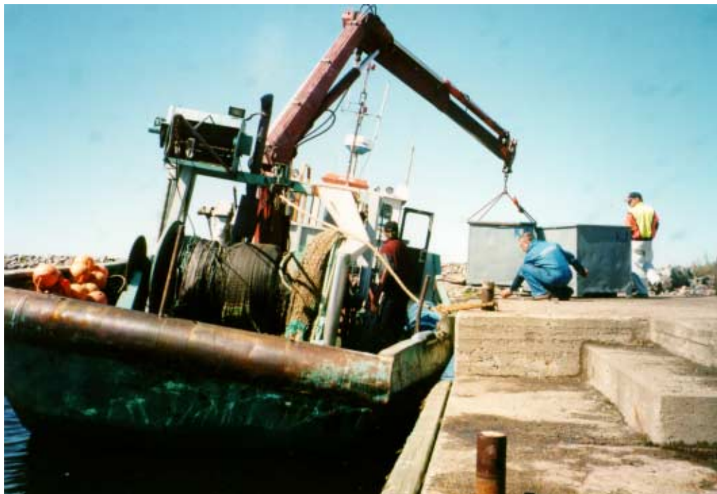
Kuva 7. TIINA II:lle tehdyn kallistuskokeen valmistelu
