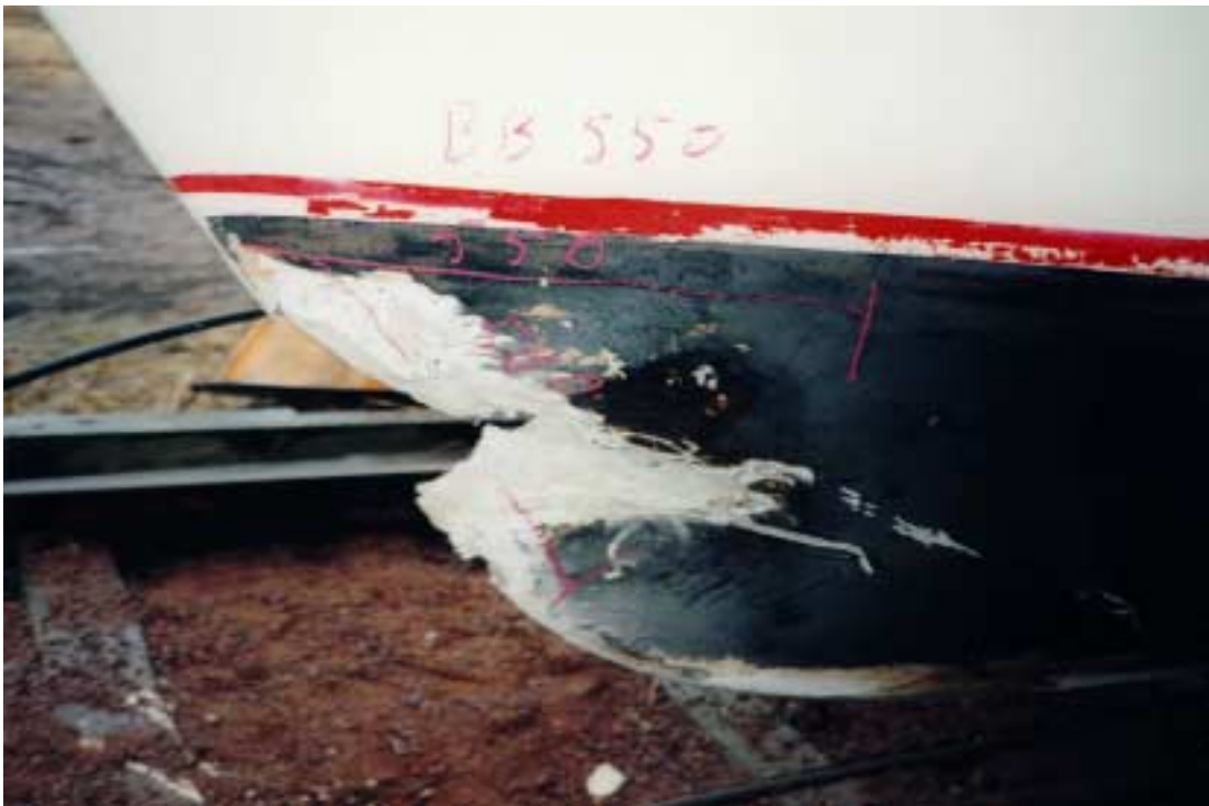
Kuva 12 c. Jäävaurio ALBATROSSENin keulassa, vasen puoli (bb)
