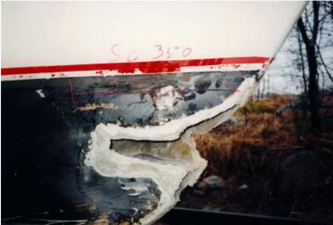
Kuva 12 b. Jäävaurio ALBATROSSENin keulassa, oikea puoli (sb)
