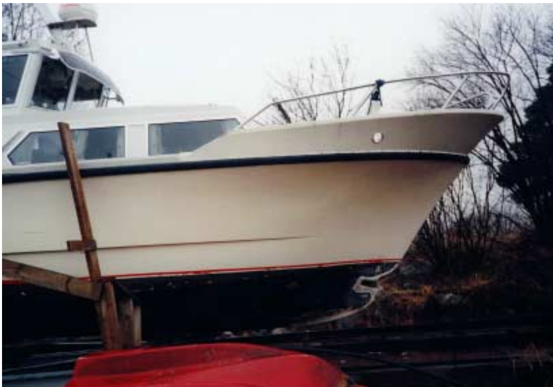
Kuva 7. ALBATROSSENin jäävaurio keularangassa merenkulun tarkastajan kuvaamana välittömästi onnettomuuden jälkeen.
