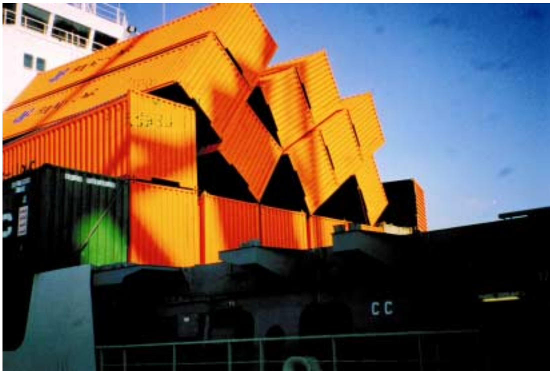
Kuva 5. Komentosillan edessä ollut konttipino romahti törmäyksessä, jolloin neljä konttia putosi mereen.
