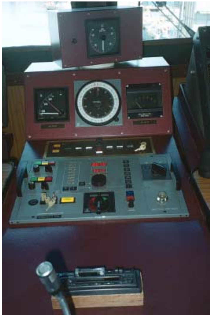
Kuva 11. Autopilotti, käsiohjaus, kompassi ja peräsinkulman mittari.
