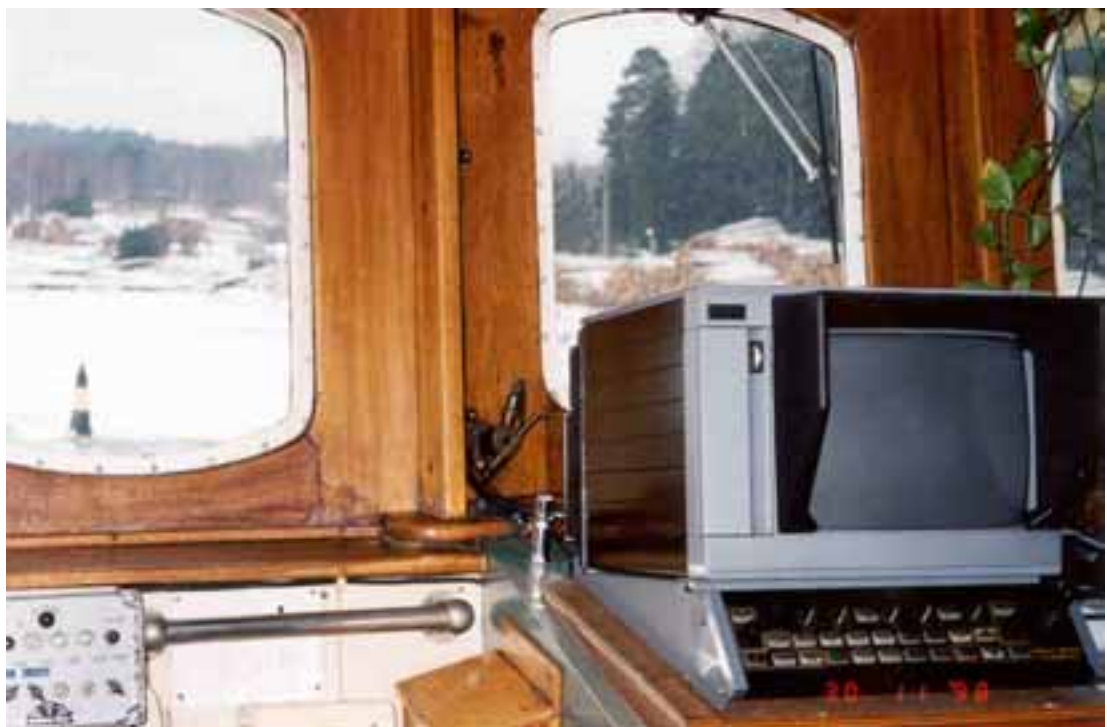
Kuva 4. Komentosillan vasemmalla puolella oleva luotsin käyttämä Decca Bridgemaster -tutka.
