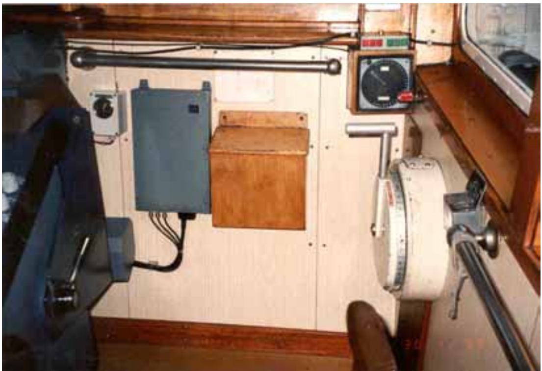
Kuva 6. Komentosillan oikeassa laidassa oleva potkurin lapakulman säätökahva.
