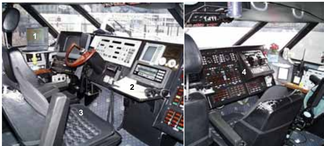
Kuva 14. LAURAn ohjaamo nykyään (toukokuu 2003): 1. Elektroninen kartta, 2. Karttapöytä, 3. Perämiehen istuin, 4. Pääkoneiden hallintalaitteet
