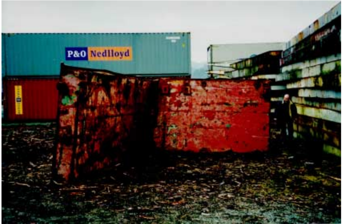
Kuva 9 Taipunut lastiluukku, huhtikuu 2000, Farsund (Onnettomuustutkintakeskus)
