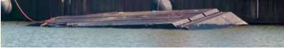
Kuva 8. Ruoppaaja ylösalaisin Tahkoluodossa jalkojen poiston jälkeen.
