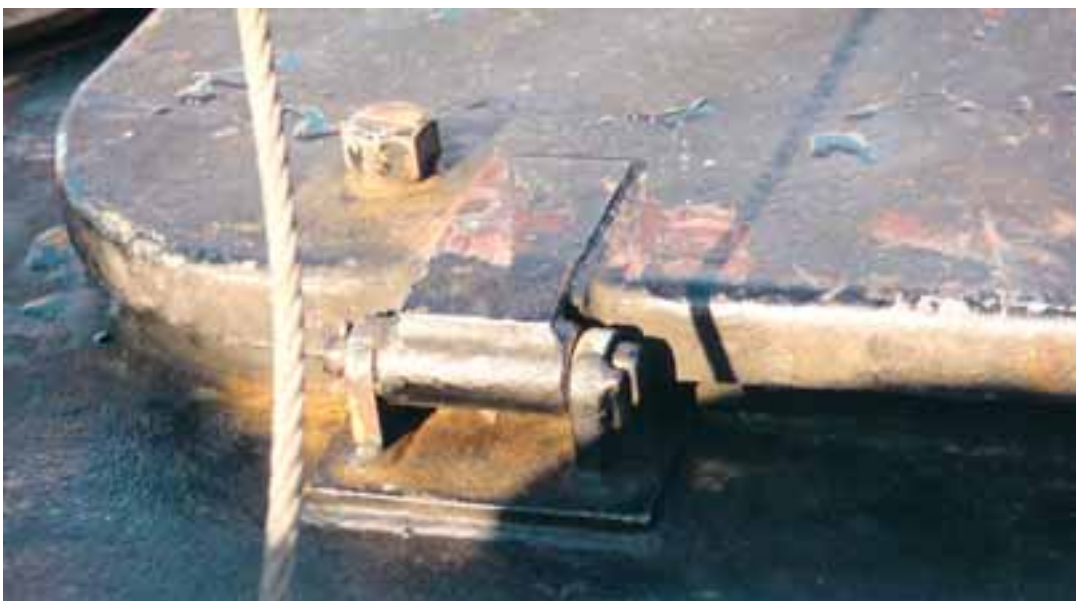
Kuva 11. Luukun mutteri, josta salpa kierretään kiinni.
