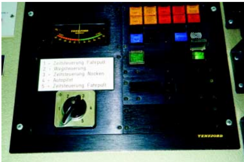
Kuva 7b. TENFJORD peräsinkoneen hallintapaneeli.
