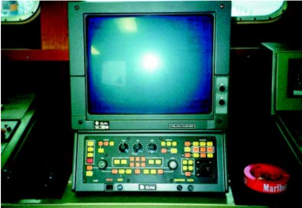
Kuva 8a. ms GRIMMin helppokäyttöinen ELNA-merkinen tutka.
