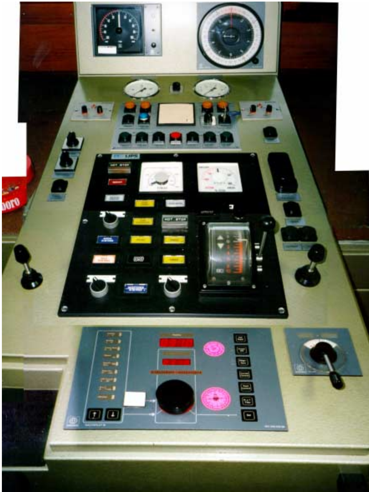
Kuva 5c. ms GRIMMin komentosillan keskikonsoli. Konsolin vasemmassa reunassa on luotsin käyttämä aikaohjaus (NFU) vipu.
