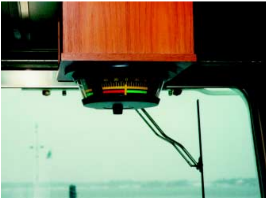
Kuva 8b. Peräsinkulman näyttölaite komentosillan katossa (sijainti näkyy myös kuvassa 2).
