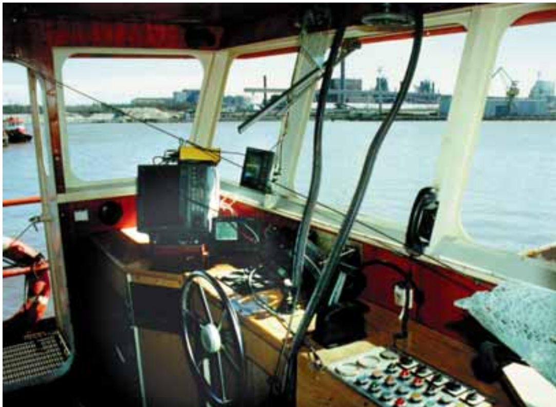
Kuva 7. CARAn ohjaamo kuvattuna välittömästi kääntämisen jälkeen. Konsolin keskellä ovat ohjauksen hallintalaitteet: ruori, ohjausjoystick, ruorikulman osoitin ja koneen kierrosluvun säätö. Konsolin oikeassa reunassa (lähellä kameraa) on palkoproomun avauksen ohjaus.
