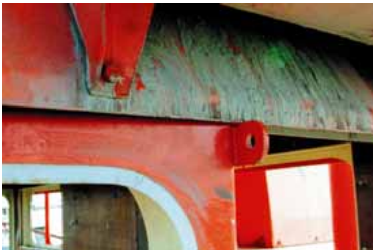
Kuva 17. CARAn oven yläpuolella oleva lipa estää oven aukenemisen oven siirtyessä ylöspäin.
