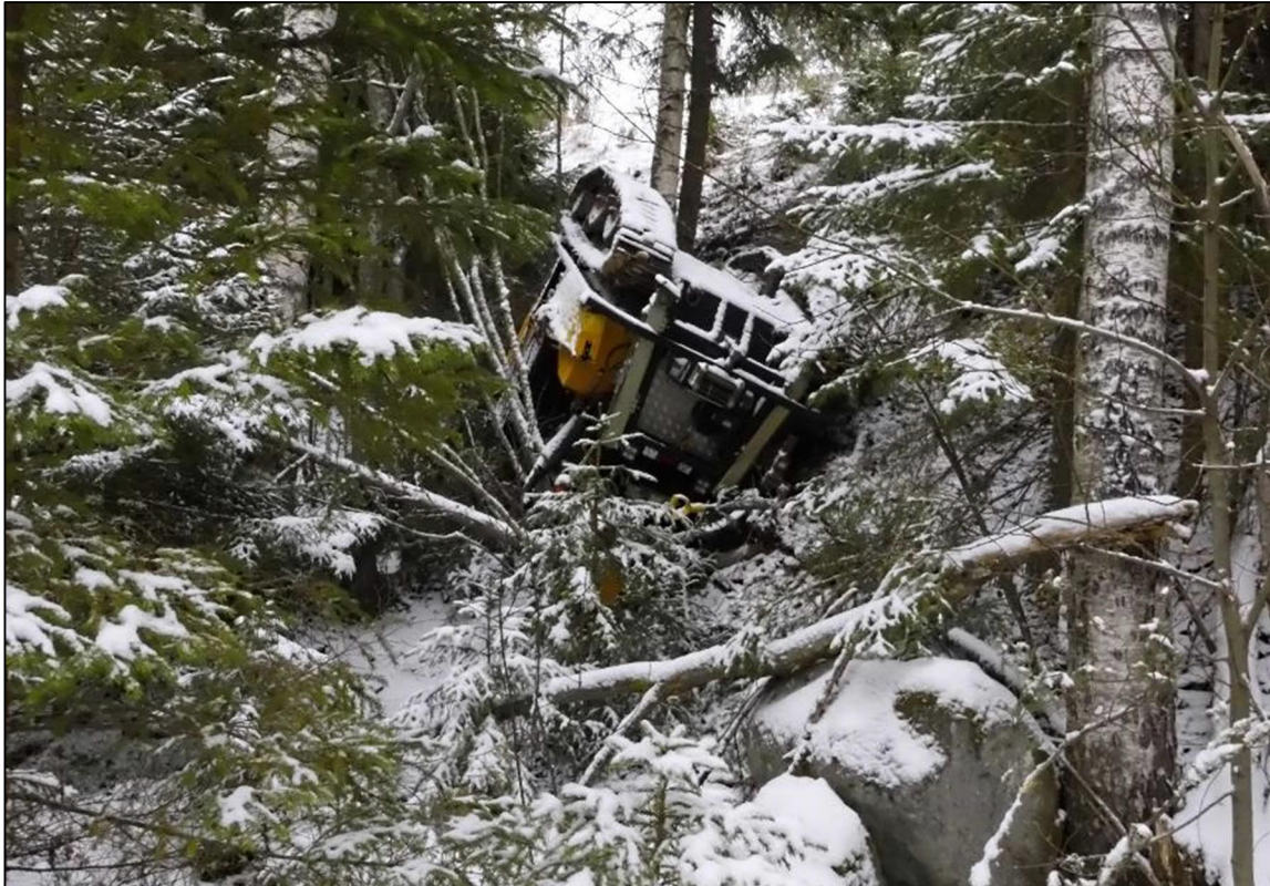
Kuva 10. Törmäyksen lisäksi kairakoneelle aiheutui vaurioita pyörimisestä jyrkän penkereen kautta kuusimetsikköön. (Kuva: OTKES)
