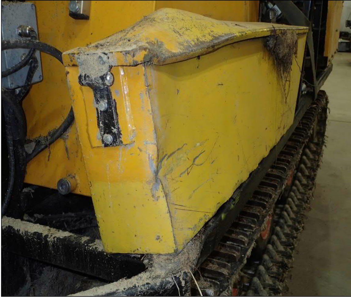
Kuva 12. Juna osui kairakoneen vasempaan etukulmaan. Kairakoneen musta runkopalkki otti vastaan törmäyksen voimaa ja suojaasi siten ylempiä osia pahemmilta vaurioilta. (Kuva: OTKES)
