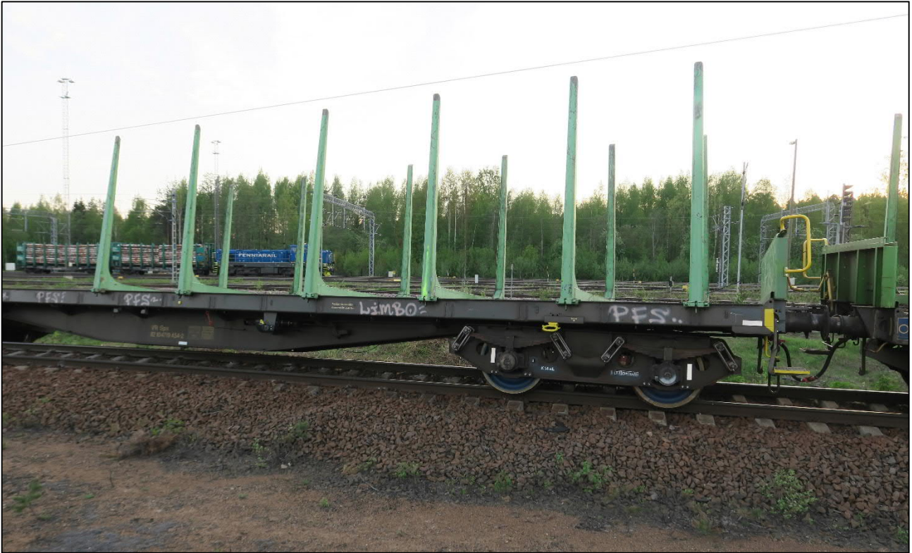
Kuva 7. Viimeisen vaunun etuteli suistuneena kiskojen oikealle puolelle. (Kuva: Poliisi)
