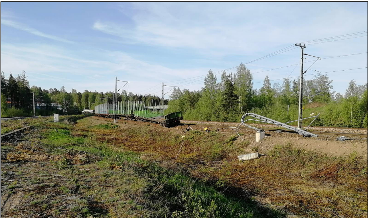
Kuva 8. Juna pysähtyneenä suistumisen jälkeen, viimeisen vaunun takateli suistuneena kiskojen vasemmalle puolelle. Kaatunut kannatinpylväs kuvassa oikealla. (Kuva: VR-Yhtymä)
