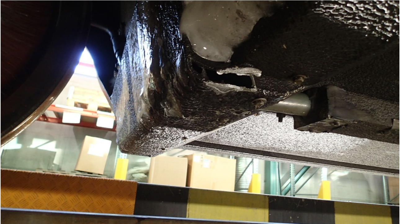
Kuva 6. Junan 2. vaunun etummaisen telin takana olevan kotelon pää oli leikkautunut auki iskuista. (Kuva: OTKES)
