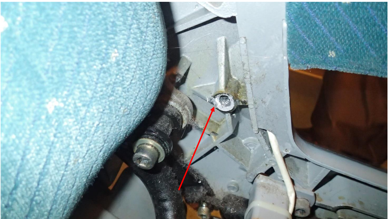
Kuva 7. Lähikuva yhdestä vaurioituneesta penkistä. Kuvassa näkyy murtunut ruuvin kiinnityskohta. (Kuva: OTKES).
