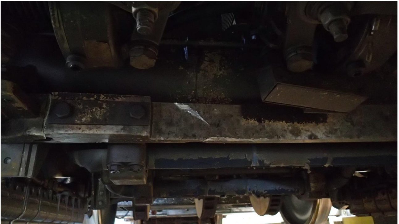
Kuva 5. Vaunun Ed 28007 taaemman telin taipunut ja murtunut kiskojarrun poikkipalkki. (Kuva: OTKES)
