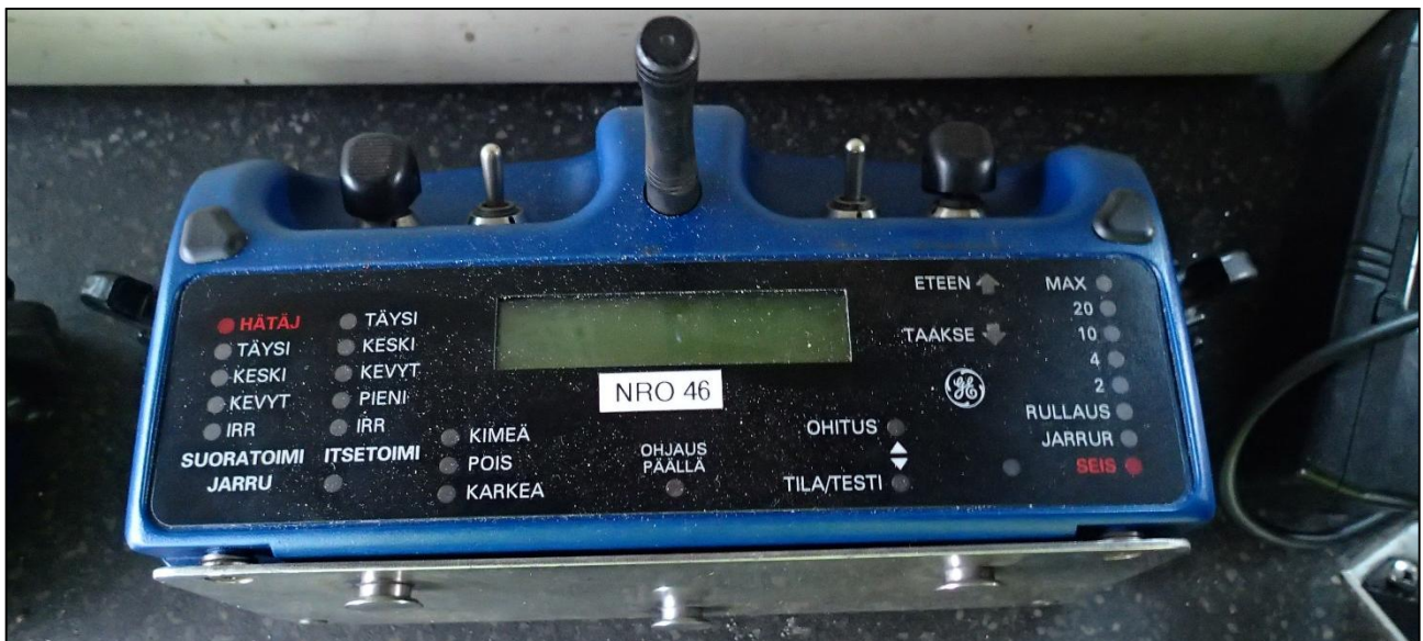
Kuva 17. GE Transportation Systems LOCOTROL-järjestelmän radio-ohjain, OCU, jollaistella vaihtotyöyksikköä ohjattiin onnettomuushetkellä. Ohjaimen vasemman reunan säätimellä ohjataan jarrutusta ja oikean reunan säätimellä veturin nopeutta. Hätäjarrutus tehdään kääntämällä ohjaimen vasemman reunan säädin täysin eteen. (Kuva: OTKES)
