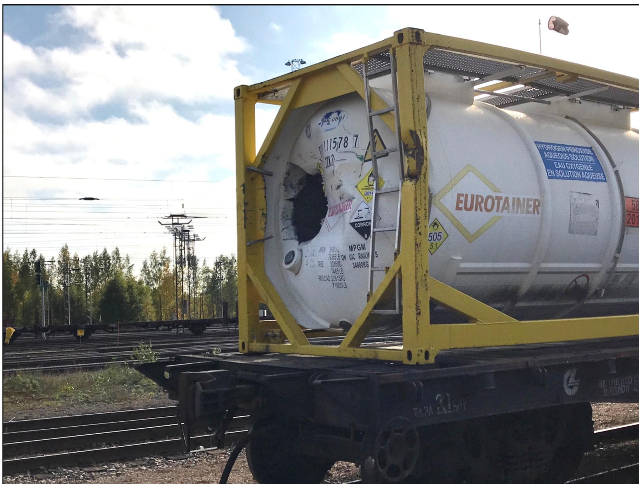
Kuva 11. Konttivaunussa olleen säiliökontin päädyn vauriot. (Kuva: OTKES)
