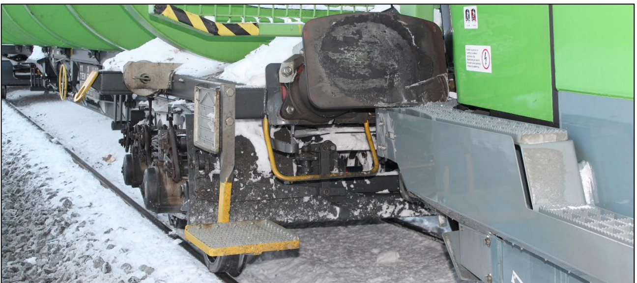
Kuva 10. Junan ensimmäisen vaunun veturin puoleinen pääty. Vaunun ensimmäinen teli on suistunut ja sivupuskin noussut veturin sivupuskimen ja aluskehysten päälle. (Kuva: OTKES)
