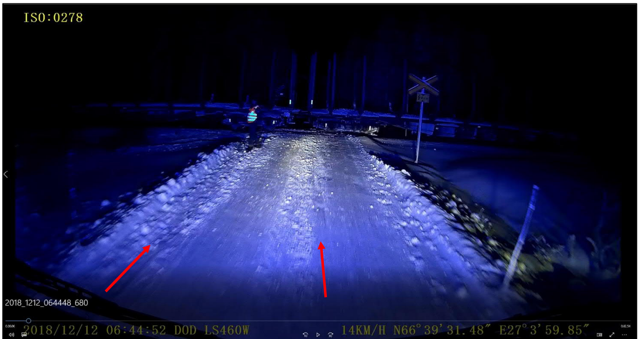
Kuva 26. Pelastuslaitoksen auton kojetaulukameran kuvassa näkyvät jätteenkeruuauton jarrutusjäljet, jotka johtavat tien vasempaan penkkaan. (Kuva: Lapin pelastuslaitos)
