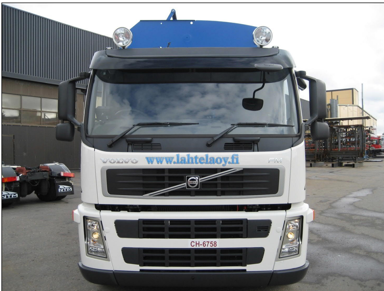
Kuva 21. Jätteenkeruuauton etunäkymä kuvattuna uutena. Kuvassa näkyvät muun muassa puskurin muoto, katolla olevat lisäkaukovalot (vaihdettu myöhemmin LED-valoihin), taustapeilien muoto ja sijoitus sekä koetaulun päällä oikean A-pilarin juuressa oleva kamerajärjestelmän näyttö. (Kuva: NTM)
