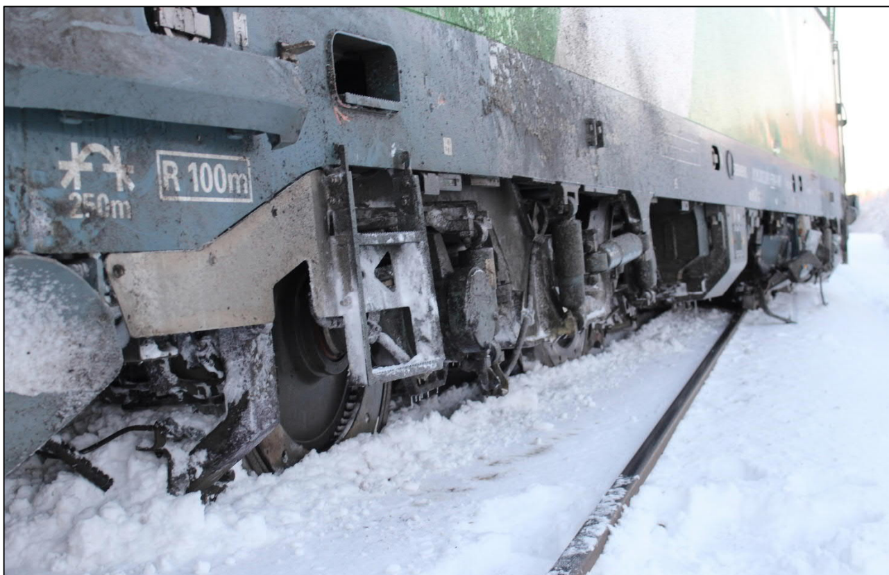
Kuva 14. Veturi suistuneena kiskojen molemmin puolin. (Kuva: OTKES)
