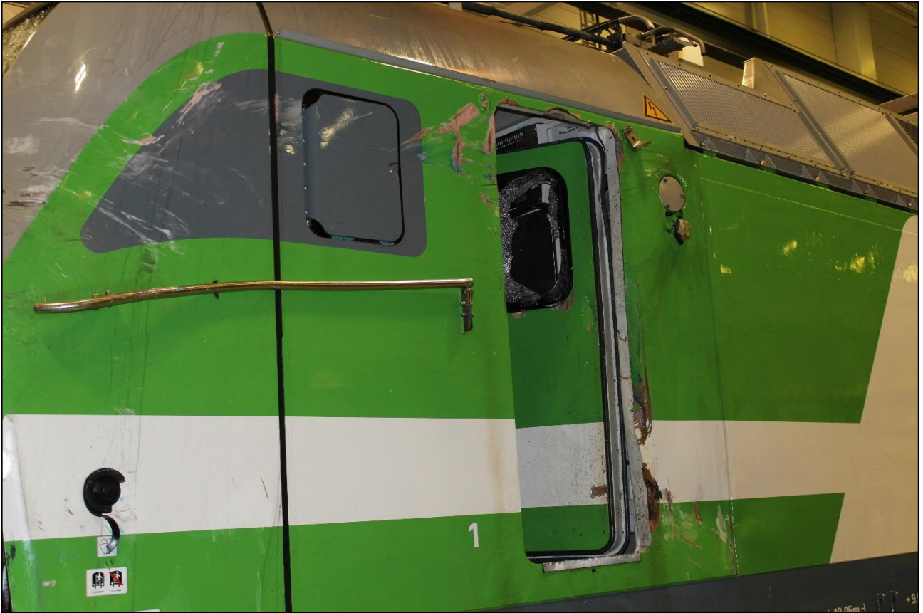
Kuva 17. Veturin vasemman etukulman ja ohjaamon oviaukon vauriot. Oviaukossa ja veturin kyljessä on sinisiä maalijäämiä autosta. (Kuva: OTKES)
