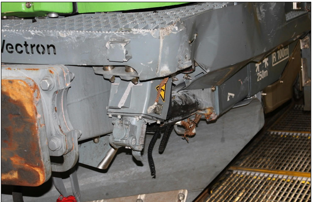
Kuva 13. Veturin vasemman etukulman törmäysvauriot. Puskinpalkin alla näkyy auton oikeasta eturenkaasta jäänyttä kumia. (Kuva: OTKES)
