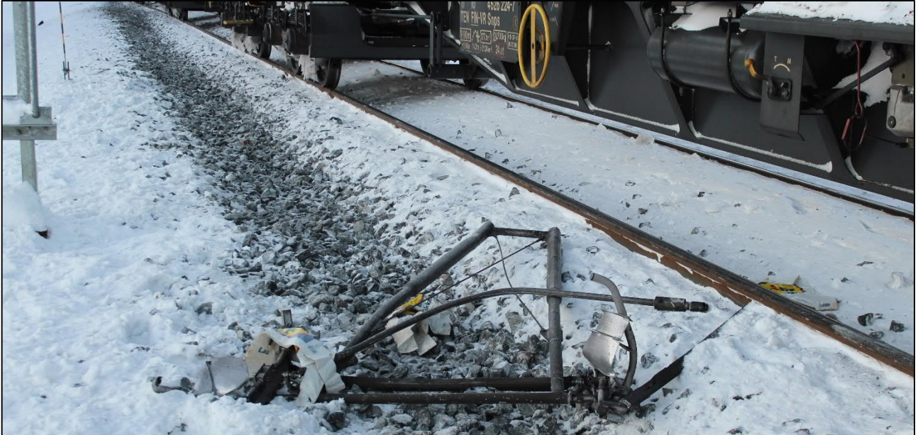
Kuva 19. Ratapenkereelle junan oikealle puolelle pudonnut veturin virroittimen yläosa (Kuva: OTKES)
