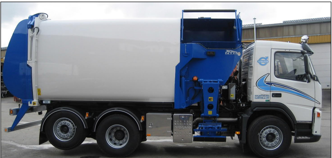
Kuva 20. Jätteenkeruuauto kuvattuna uutena päällirakenteen valmistaneen tehtaan pihalla. Kuvien oton jälkeen autoon asennettiin keruusäiliön taakse nosturi. (Kuva: NTM)
