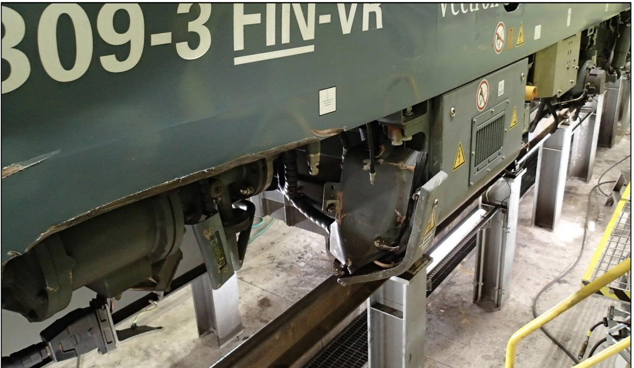
Kuva 18. Auton takaosan osumakohta veturin kyljessä. Kuvassa tuhoutunut akustosulakekotelo ja vaurioitunut päämuuntajan öljypumppu. Veturin sivupalkki on taipunut. (Kuva: OTKES)
