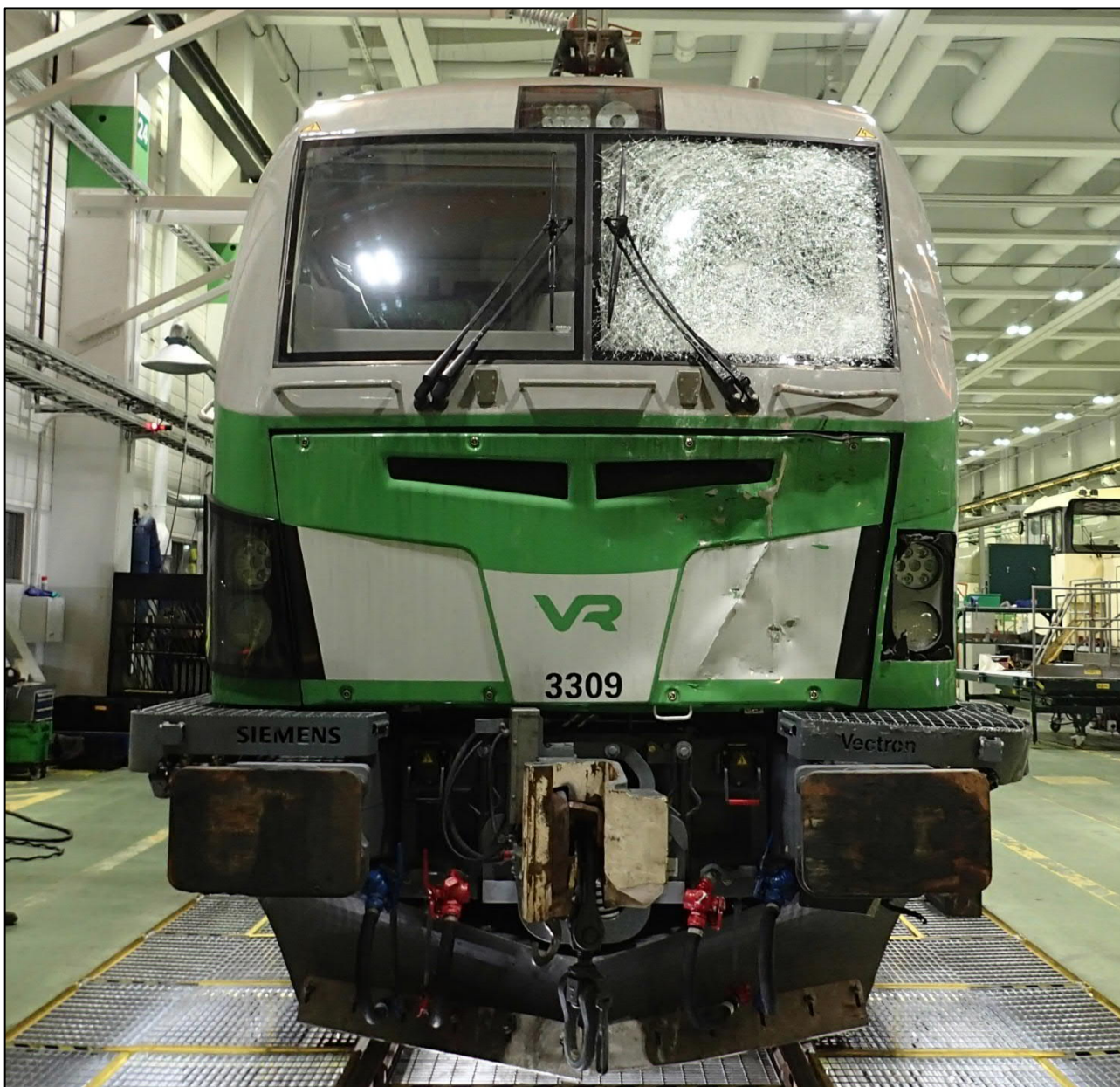
Kuva 7. Veturin keulan vauriot. (Kuva: OTKES)
