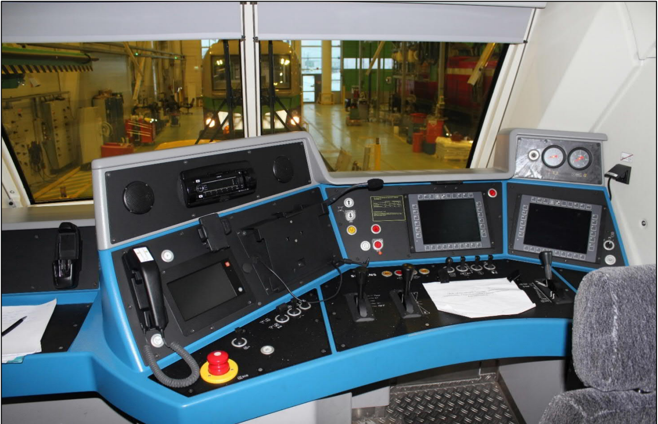
Kuva 12. Sr3-veturin ohjaamo ja ajopöytä. Lisätyt konsolit ovat harmaat osat alkuperäisen sinisen ajopöydän päällä. (Kuva: OTKES)
