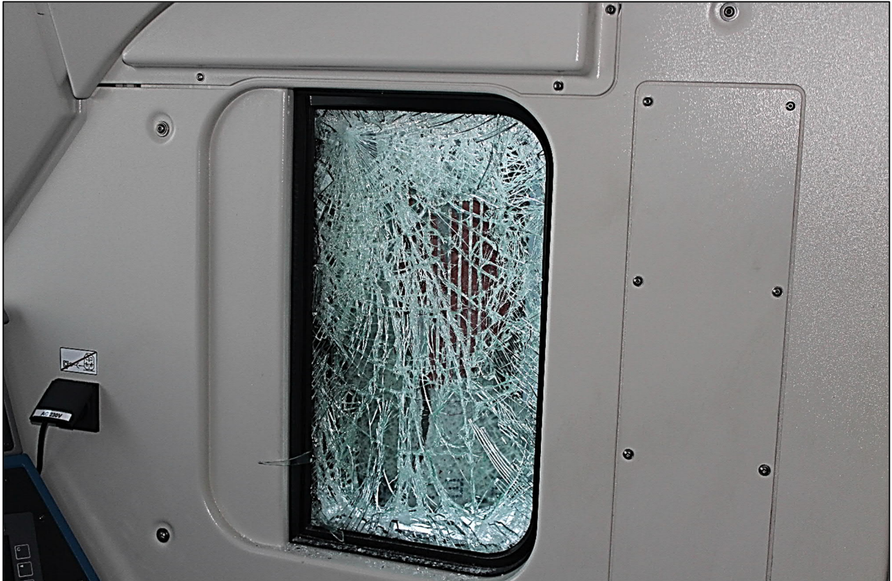
Kuva 16. Veturin oikean peilin tähystysikkuna, joka on rikkoontunut pitkiksi teräviksi sirpaleiksi. (Kuva: OTKES)
