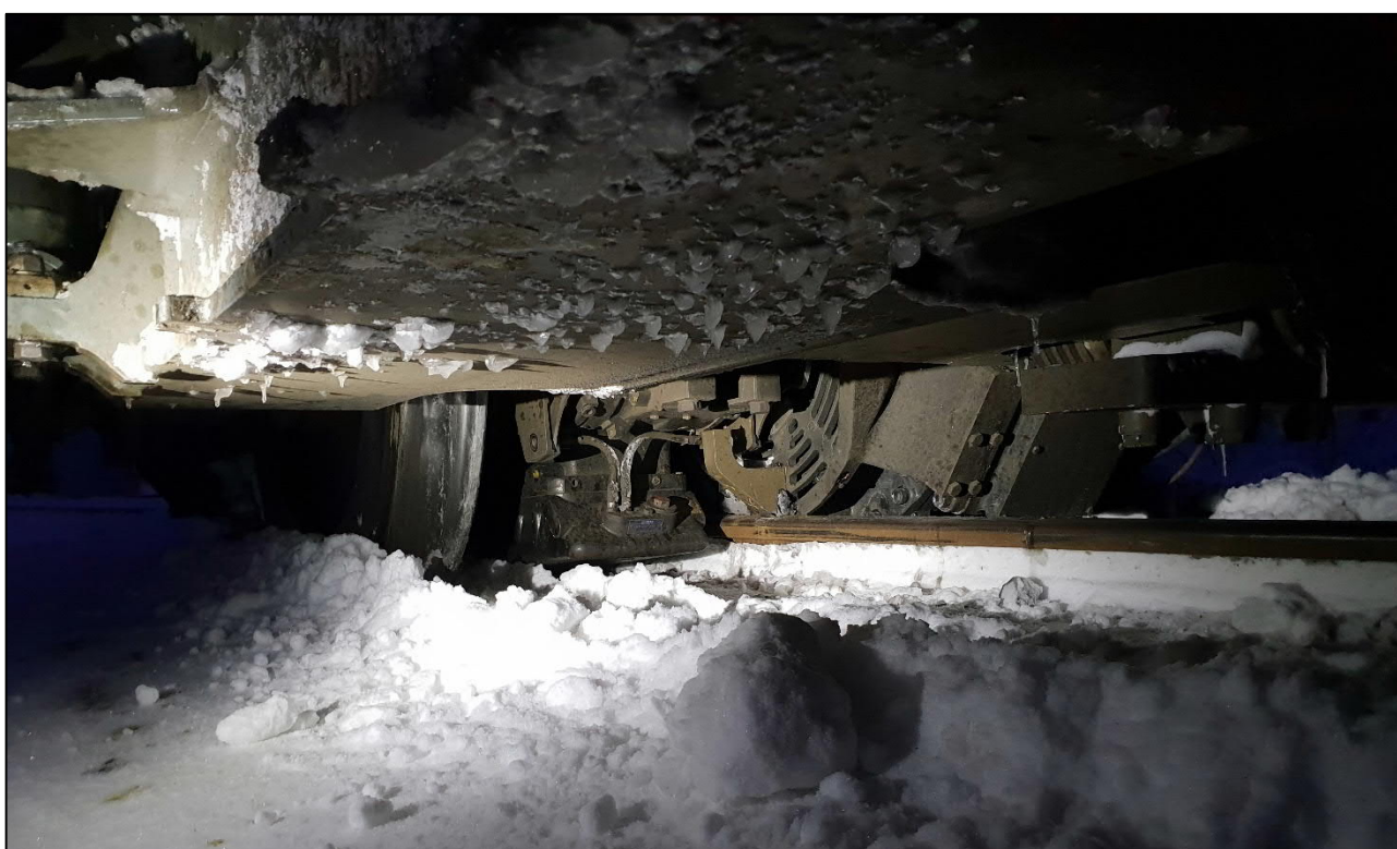
Kuva 15. Veturin suistunut takateli. Kuvassa näkyy, kuinka kisko jäi suistumisen jälkeen akselinkäyttölaitteen ja ajomoottorin väliin ja piti veturin paikallaan sivusuunnassa. (Kuva: OTKES)
