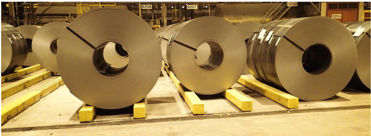
Kuva 16. Kelojen vierimistä estäviä kehtorakenteita varastoalueella. (Kuva: OTKES)
