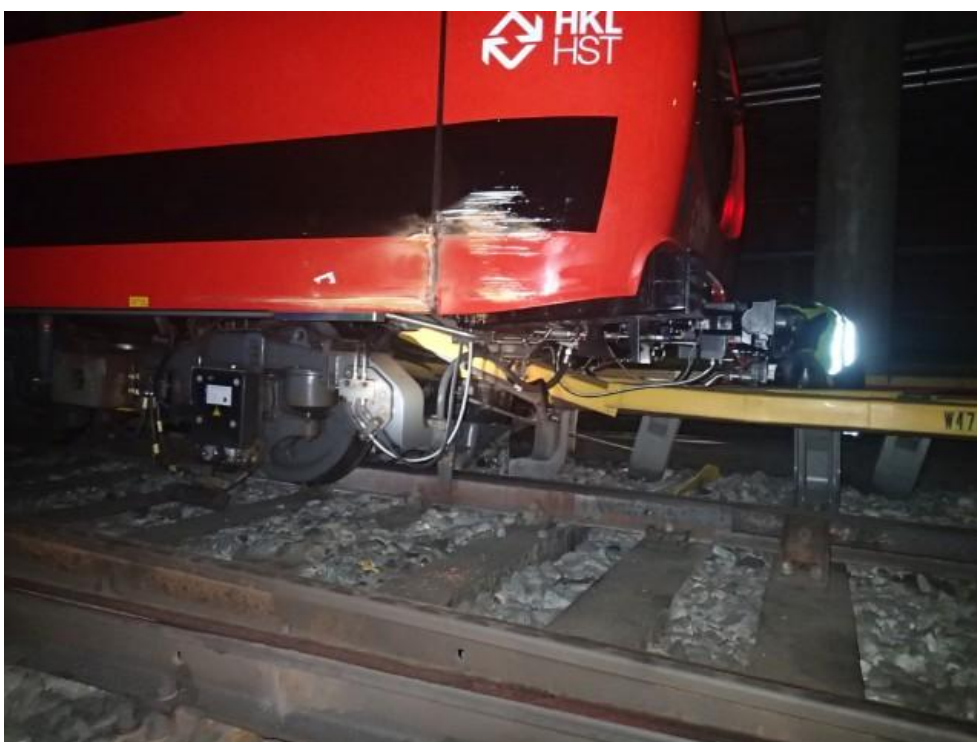
Kuva 10. Virtakisko tunkeutui koeajojunan lattiarakenteiden läpi. (Kuva: OTKES)
