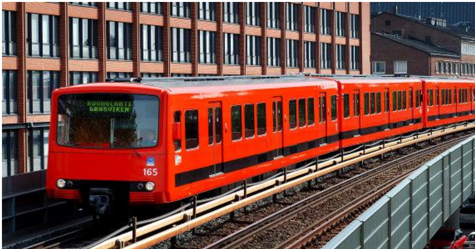
Kuva 12. M100-sarjan metrojuna. (Kuva: HKL)
