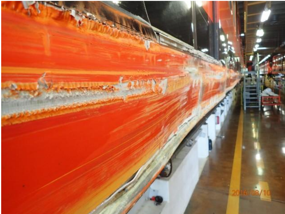
Kuva 11. Opetusjunan O41 kylkeen tuli painaumia ja naarmuja. (Kuva: OTKES)
