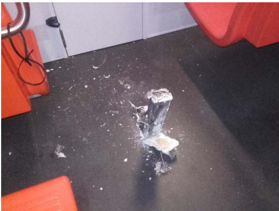
Kuva 9. Virtakiskon pää tunkeutui suistuneen koeajojuna X02:n lattian läpi matkustamotilassa ohjaamon takana. (Kuva: HKL)
