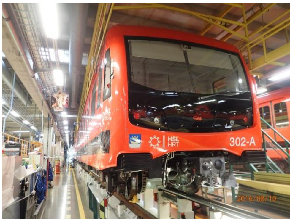
Kuva 8. Onnettomuudessa suistuneen koeajojuna X02:n teliin, alustarakenteisiin ja kylkeen tuli vaurioita. (Kuva: OTKES)
