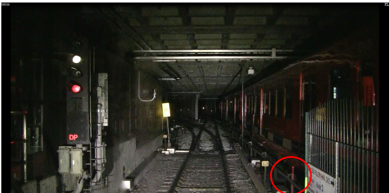
Kuva 17. Liikenteenohjaaja antaa metrojunankuljettajalle radiopuhelimella poikkeusopasteen. Opastimessa opaste näkyy kuljettajalle valkoisena ja punaisena valona. Rajamerkki ympyröitynä oikeassa alareunassa. (Kuva: OTKES)
