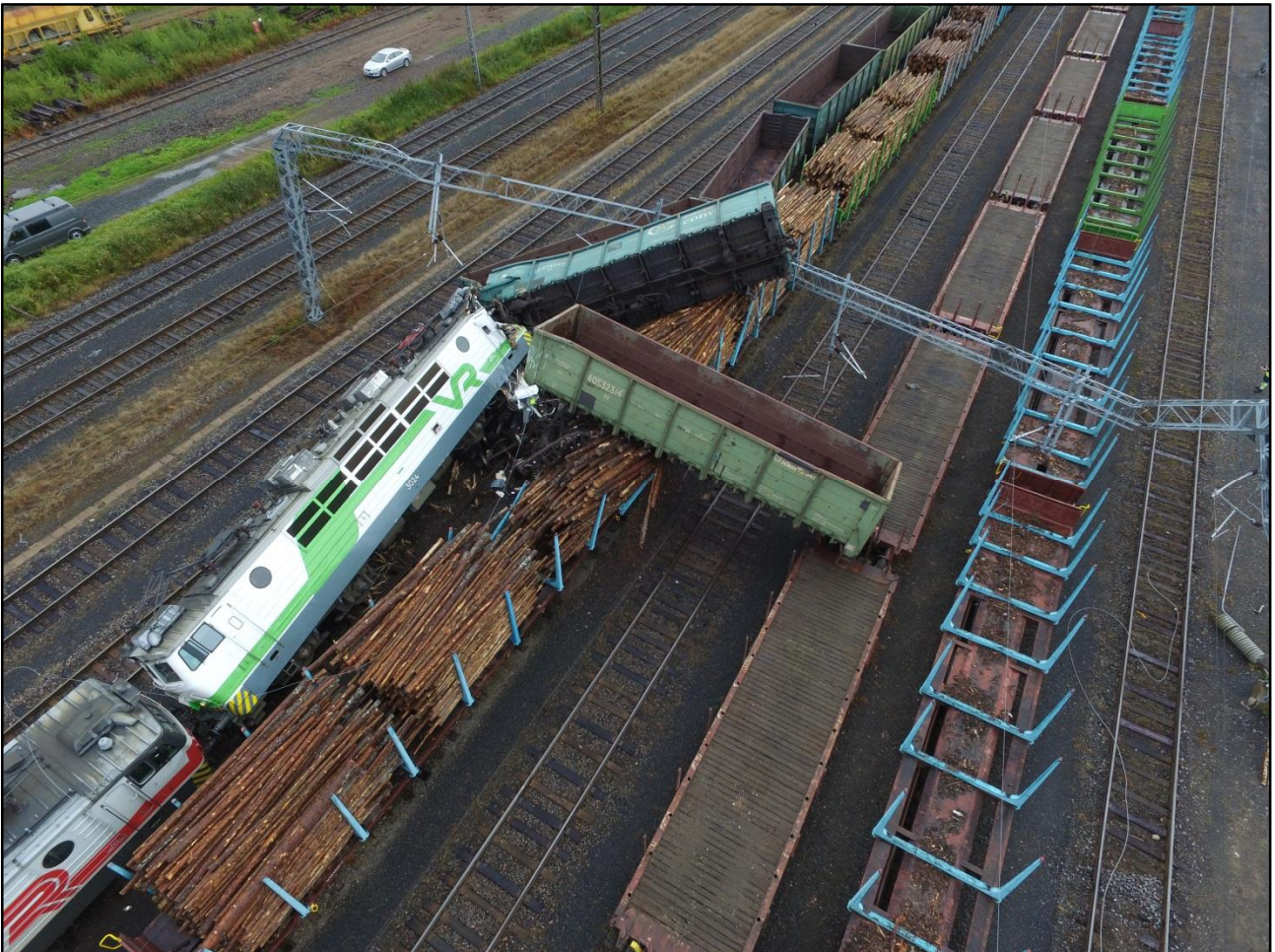
Kuva 3. Törmännyt veturi vaurioitui pahoin muun muassa oikeasta etukulmastaan. Kuvassa näkyy myös vaurioitunut sähkörataportaali. (Kuva: Poliisi)
