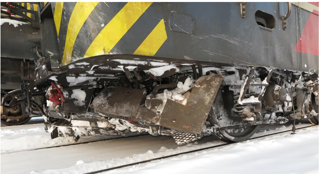
Kuva 2. Veturin alle kiilautunut auton keulaosa ja tasoristeyksen kansi vaurioittivat veturin keulaa ja alustan laitteita. (Kuva: Poliisi)
