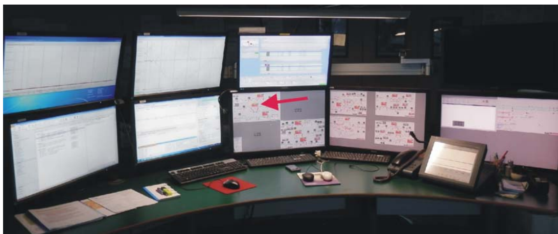
Kuva 4. Seinäjoen ohjauspalvelun yksi liikenteenohjauspöytä. Pöydässä on kahdeksan näyttöä. Laihia on alarivissä vasemmalta kolmannen näytön vasemman yläkulman ikkunassa keskellä (punainen nuoli).
