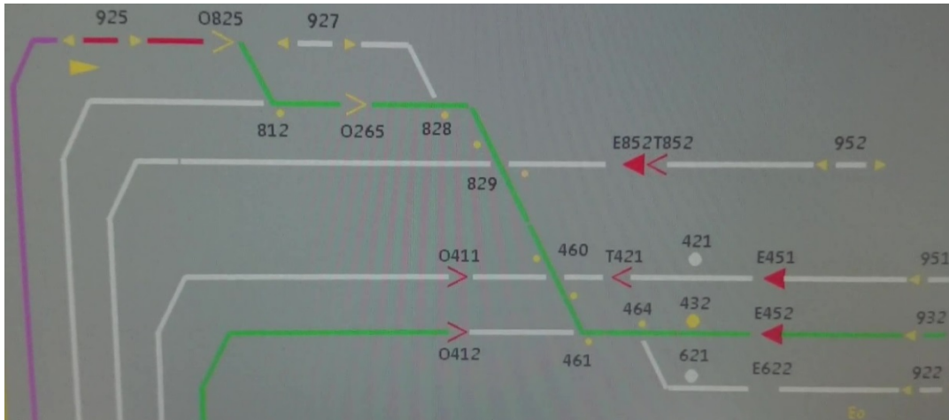
Kuva 2. Juna saapuu opastimelle O825. Karjalan pääradalle raideopastimen O412 länsipuolelle tulee vihreä väri; mahdollisesti kyseessä on lännessä olevan junan ohiajovara.
