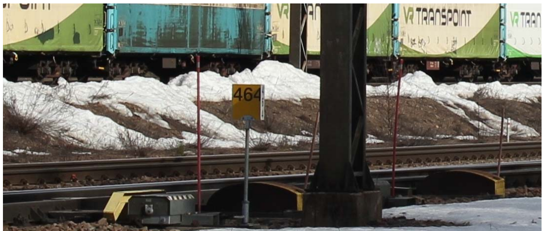
Kuva 5. Vaihde V464. Vaihteen merkissä vaihteen numero on vaakasuorassa keltaisella pohjalla, joka tarkoittaa, että vaihde on käännetty poikkeavalle raiteelle, eli Kotkan suuntaan.
