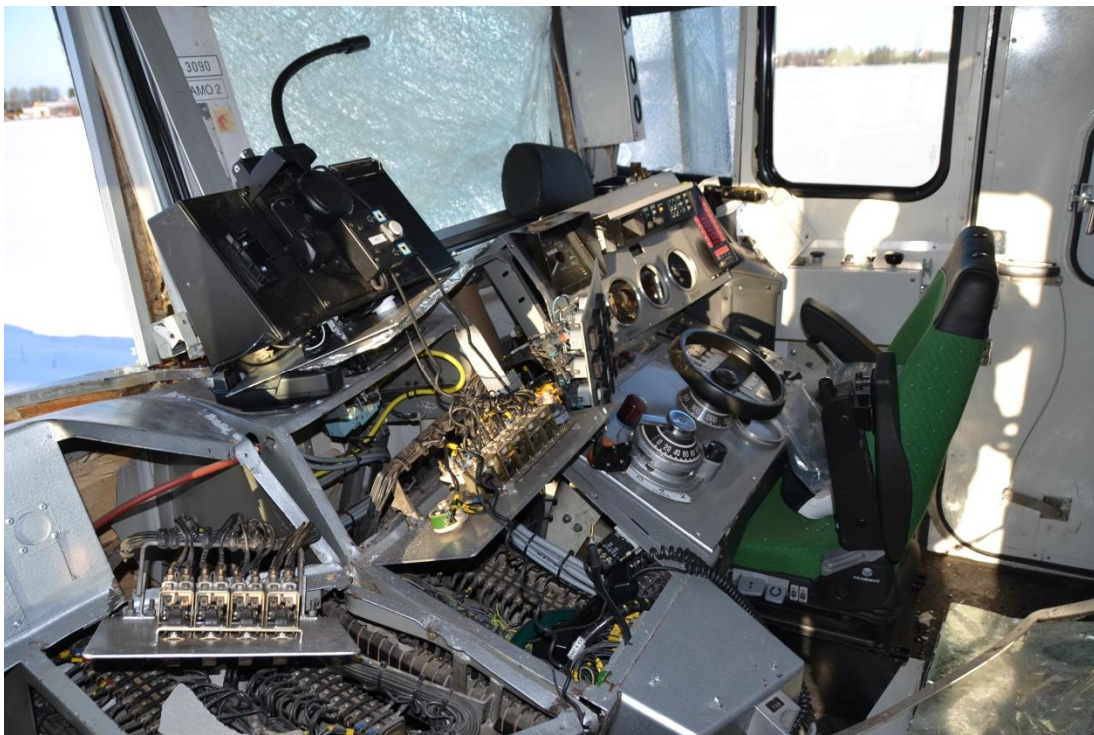
Kuva 5. Veturin ajopöytä työntyi törmäyksen voimasta istuimeen asti.
