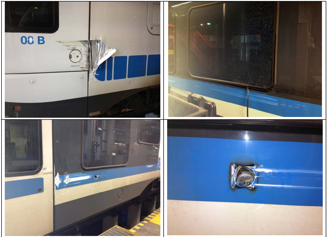
Kuva 2. Junaan aiheutuneita vaurioita.
