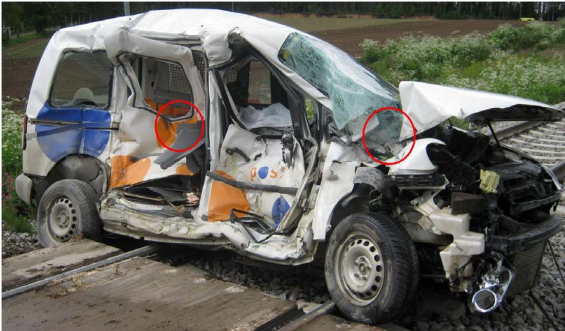
Kuva 2. Onnettomuusajoneuvo. Veturin puskimien osumakohtat on merkitty punaisilla ympyröillä.
